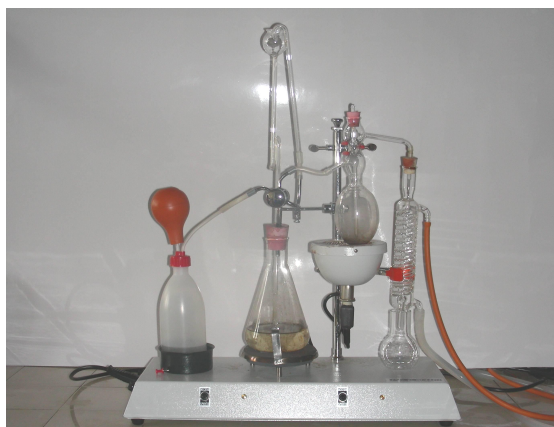
Fig. 2 - Acidimetro di Juffmann
