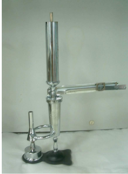
Fig. 1 - Ebuliometro di Malligand
