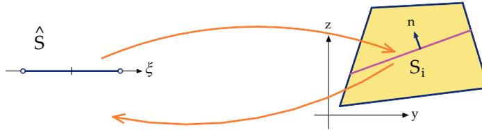
Figura 3.13: Intefaccia: trasformazione tra elemento master ed elemento in coordinate geometriche.
