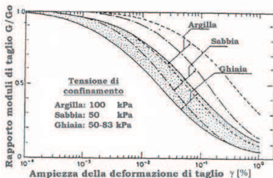
Figura 6.3 - Curve di decadimento normalizzate ricavate per alcuni terreni naturali (Imazu - Fukutake, 1986).
