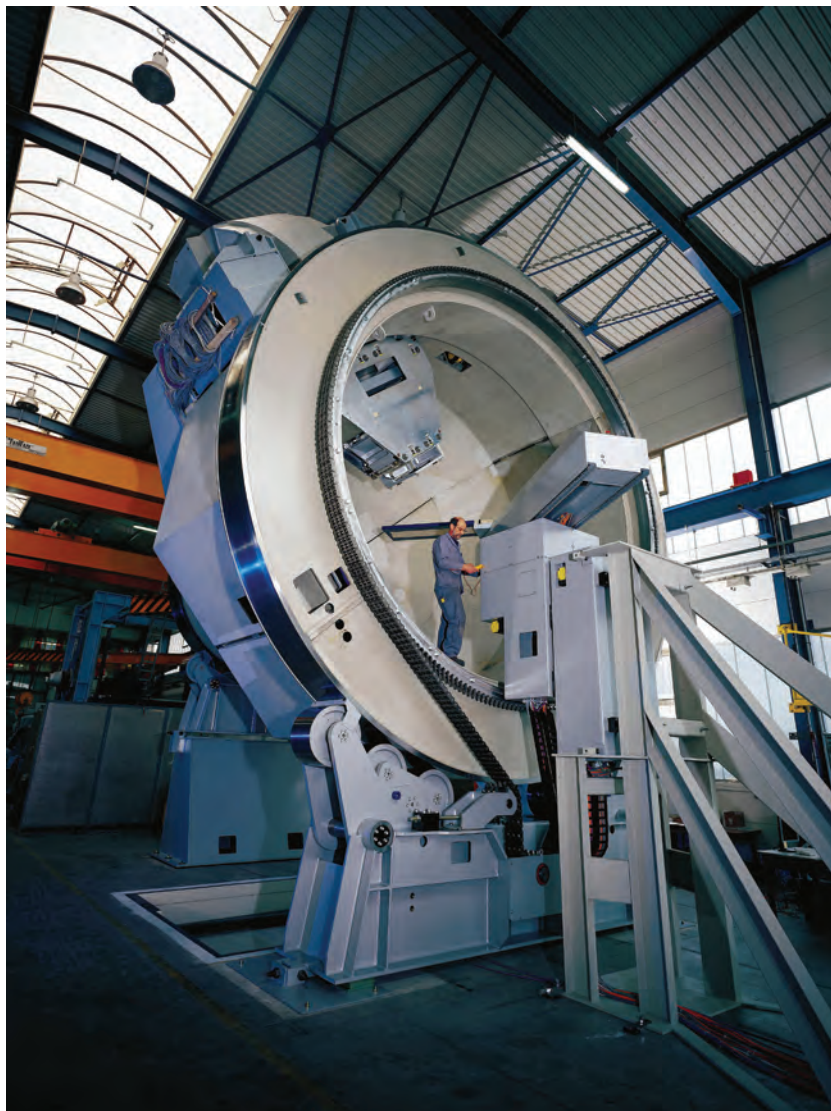
Fig. 13 Esempio di camera rotante in fase di costruzione. Il fascio in questa struttura può raggiungere il bersaglio da direzioni provenienti a 360° attorno al paziente posto sul lettino di terapia
