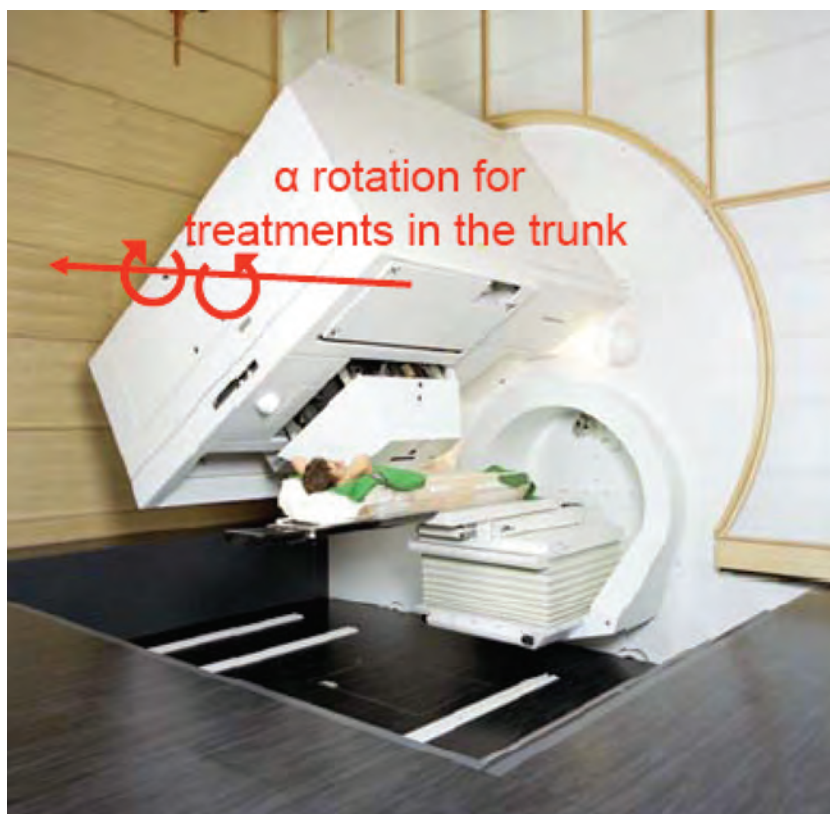
Fig. 14 La camera rotante (eccentrica) in funzione al PSI (Villigen –Svizzera)
