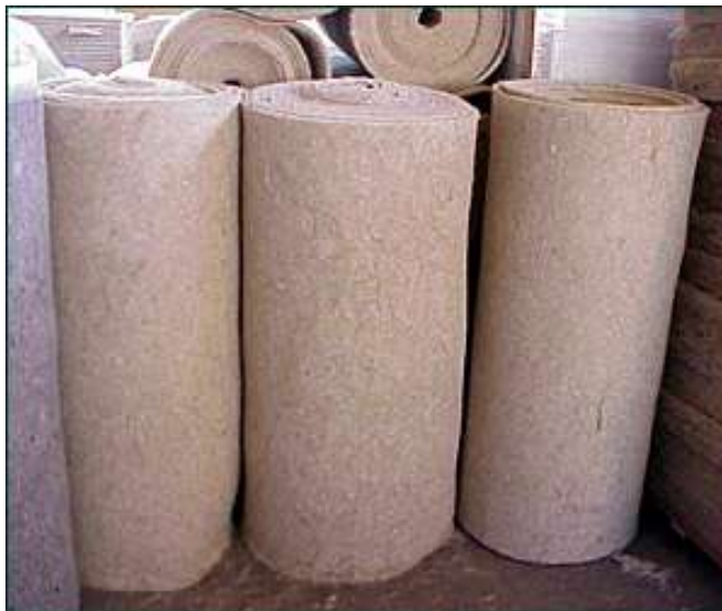
Fig.4.3 Rotoli di tessuto non tessuto di fibre di canapa
