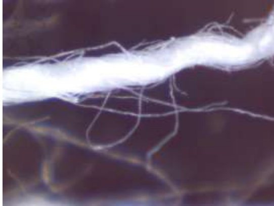
Fig.4.9 Immagine al microscopio ottico (200x) delle fibre ritorte del B6240
