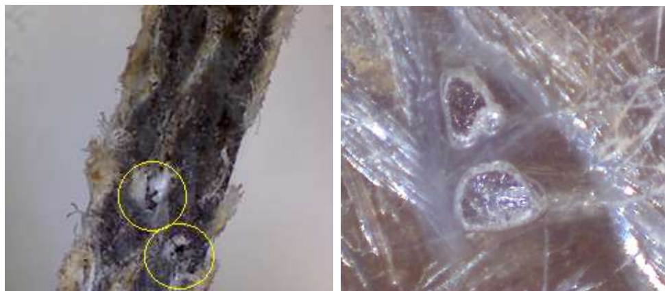
Fig. 4.116 Scansione al microscopio ottico di due sezioni di laminati rinforzati rispettivamente con Biotex e B6240C in cui si vede la presenza di macrovuoti
