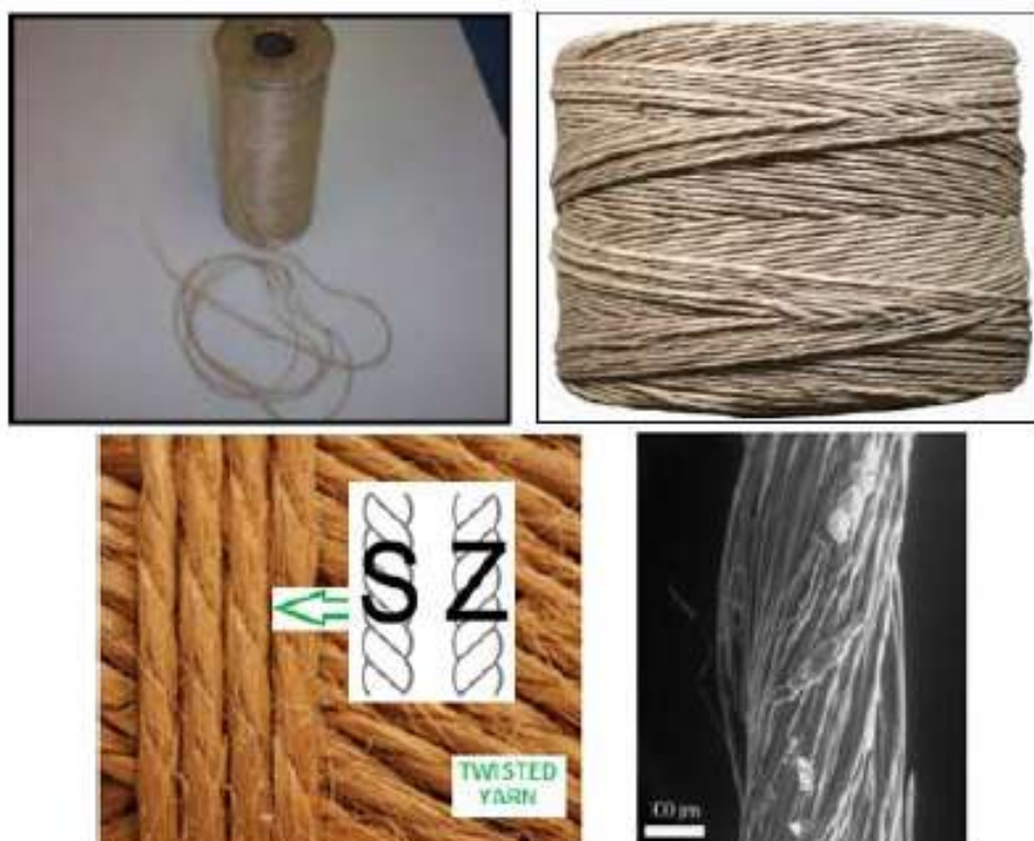
Fig. 1.30 Yarn di canapa e microscopia a scansione elettronica (SEM) di un yarn di canapa
