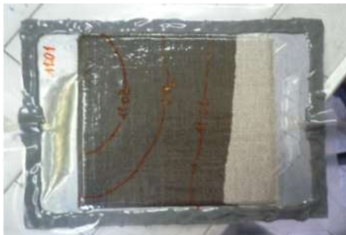
Fig. 4.36 Una fase del processo di iniezione della resina, con l'annotazione del fronte di avanzamento nel tempo
