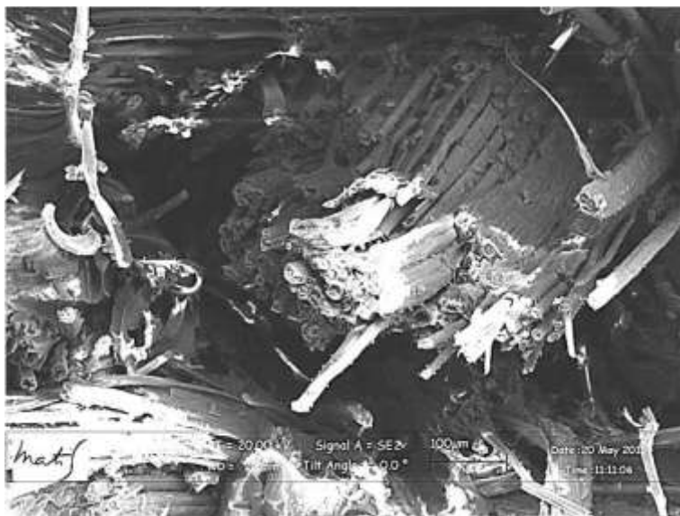
Fig. 4.120 Scansione al SEM della superficie di frattura di un provino di composito rinforzato con tessuto B607 testato a trazione: particolare del fenomeno di pull-out dello yarn
