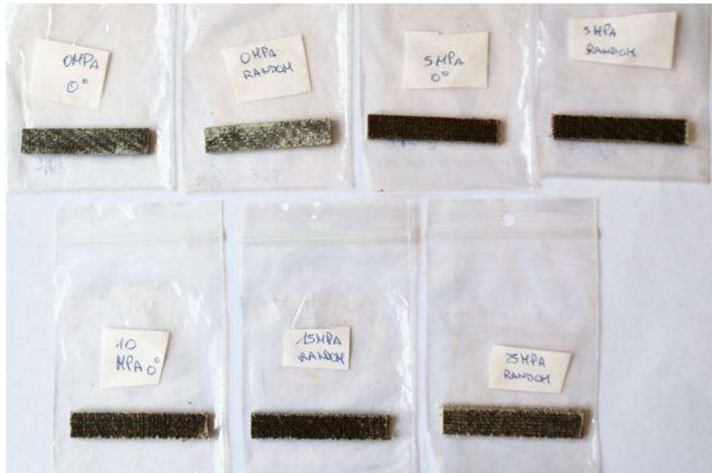
Fig. 4.55 Alcuni provini di composito con tessuto Biotex pronti per la prova DMA
