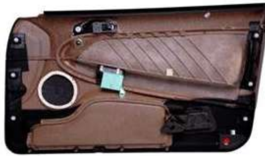
Fig. 1.54 Pannello realizzato in WOOD-STOCK
