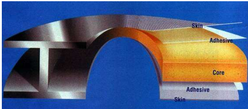
Fig. 1.70 Similitudine tra un pannello sandwich ed una trave a doppia T
