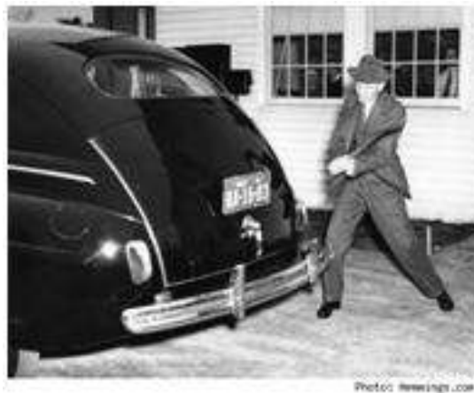
Fig. 1.46 Henry Ford che dimostra le resistenze di un autovettura realizzata in canapa e resina a base di soia
