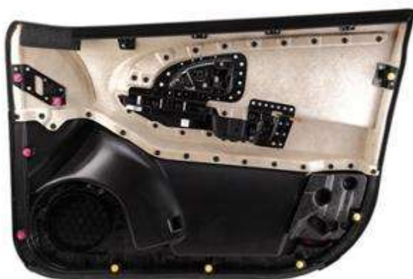
Fig. 1.48 Pannello per sportello in Fibrowood
