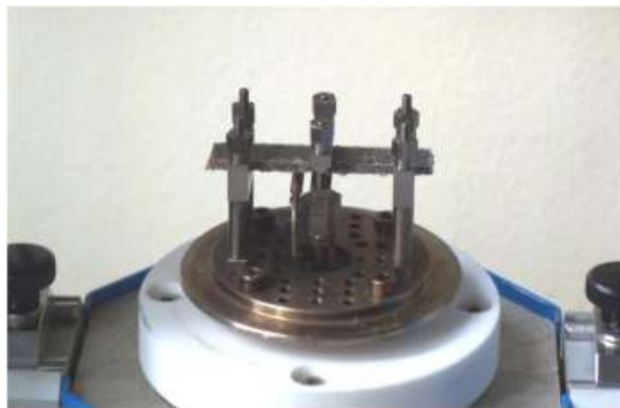
Fig. 4.54 Particolare del portacampione per la prova DMA a flessione su tre punti
