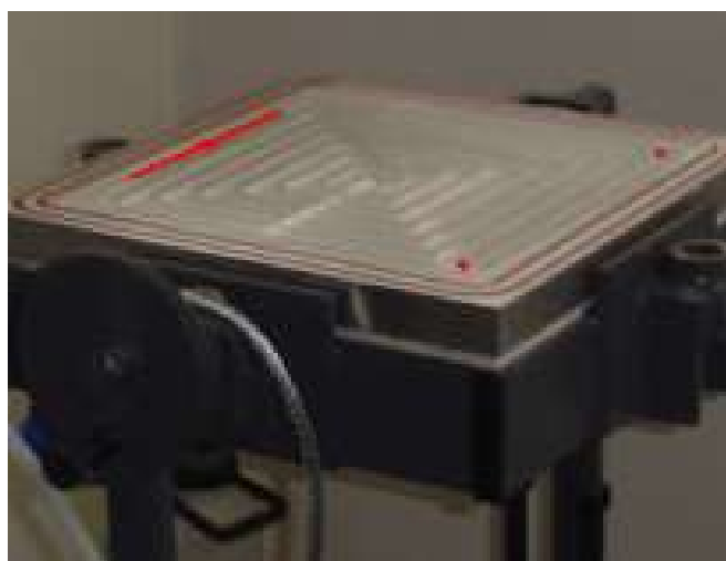
Fig.4.28 Zona di iniezione e punti di fuoriuscita della resina all'interno della cavità dello stampo
