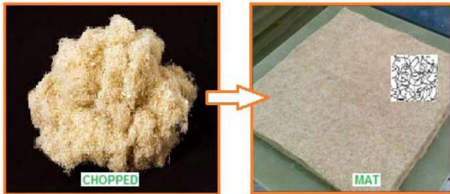
Fig. 1.42 Tessuto non tessuto di fibre di canapa
