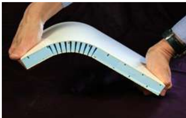
Fig. 1.81 Intagli per realizzare una superficie curva
