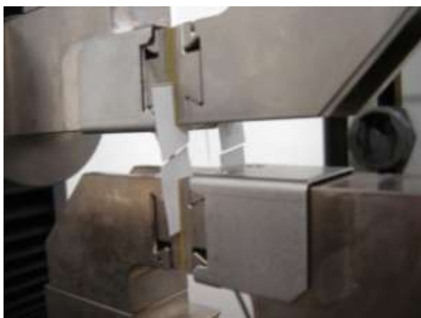
Fig.4.22 Prova di trazione di una fibra estratta dal Mat
