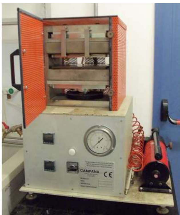
Fig. 4.37 Pressa utilizzata per la fase di Hot Press Curing, a disposizione del ICTP del CNR di Catania
