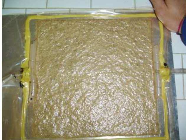
Fig. 4.34 Fasi della preparazione dello stampo: posizionamento del sacco da vuoto e prova della tenuta del vuota prima della fase di iniezione
