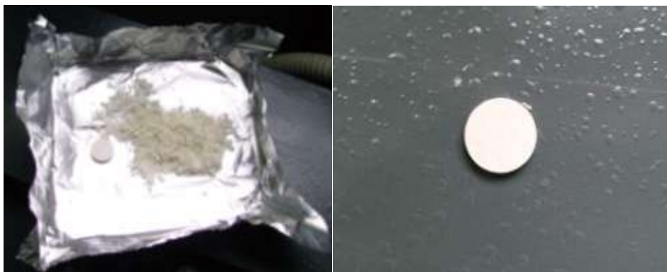
Fig.4.18 Cilindro ottenuto dalla compattazione delle fibre
