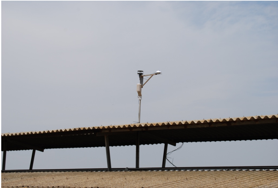
Figura 9 – Sensori per la misurazione dei dati termo-igrometrici all'esterno dell'edificio zootecnico
