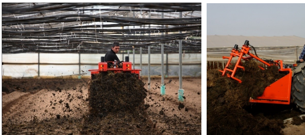
Fig. 8.4 – Prove di carico e di distribuzione svolte con materiale organico
