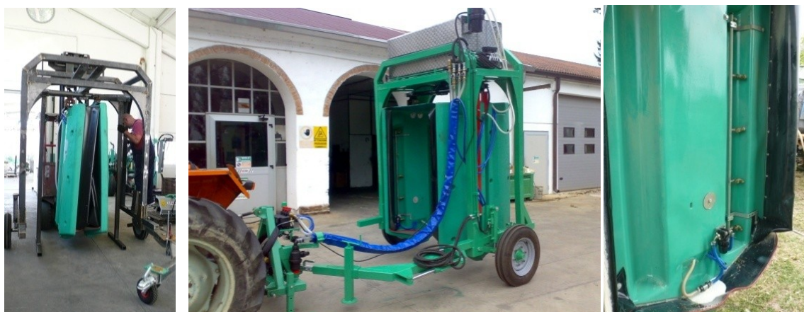
Fig. 9.10 – Sistema di distribuzione a tunnel e sue componenti: pareti captanti, barra portaugelli e vaschetta di recupero.
