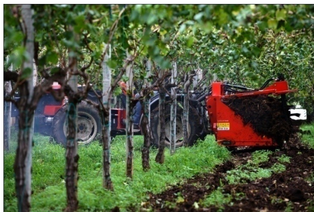
Fig. 8.5. Prova macchina spandicompost in vigneto
