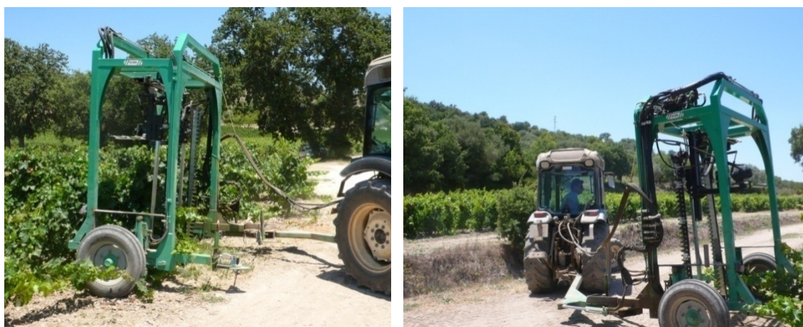
Fig. 9.17 – Manovre del portale mentre esegue la cimatura.
