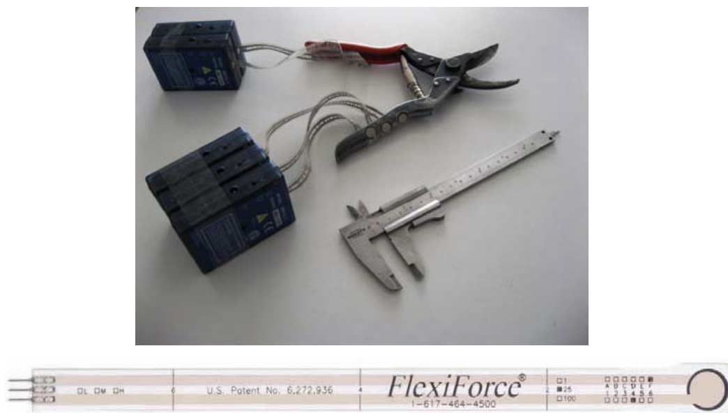
Fig. 6.3.1. – Cesoia sensorizzata e sensore per misurare la forza FlexiForce .
