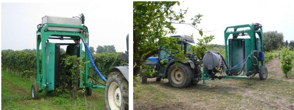
Fig. 9.12 – Modifiche apportate per alloggiamento e posizione serbatoio per la miscela fitoiatrica (foto sx I allestimento, foto dx allestimento attuale).
