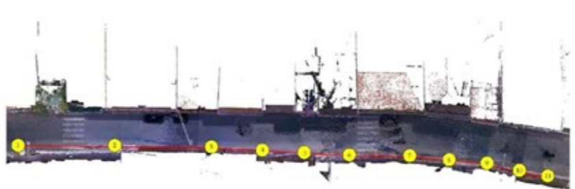
Vista dall'alto nuvola di punti e posizione scansioni
