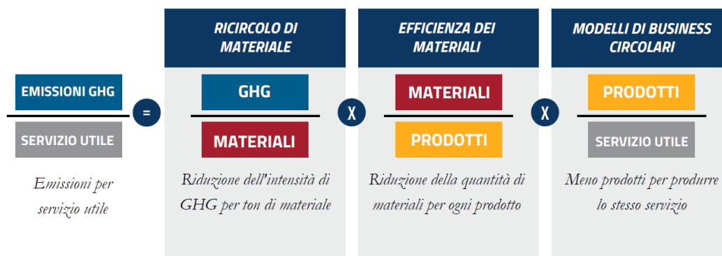
Figura 10 - Riduzione delle emissioni dal processo di produzione e consumo di materiali (Fonte Material Economics traduzione propria)
