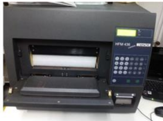
Figura 48 – Termoflussimetro HFM 246 – lambda presso l'Escuela Técnica Superior de Arquitectura, Università Politecnica di Madrid
