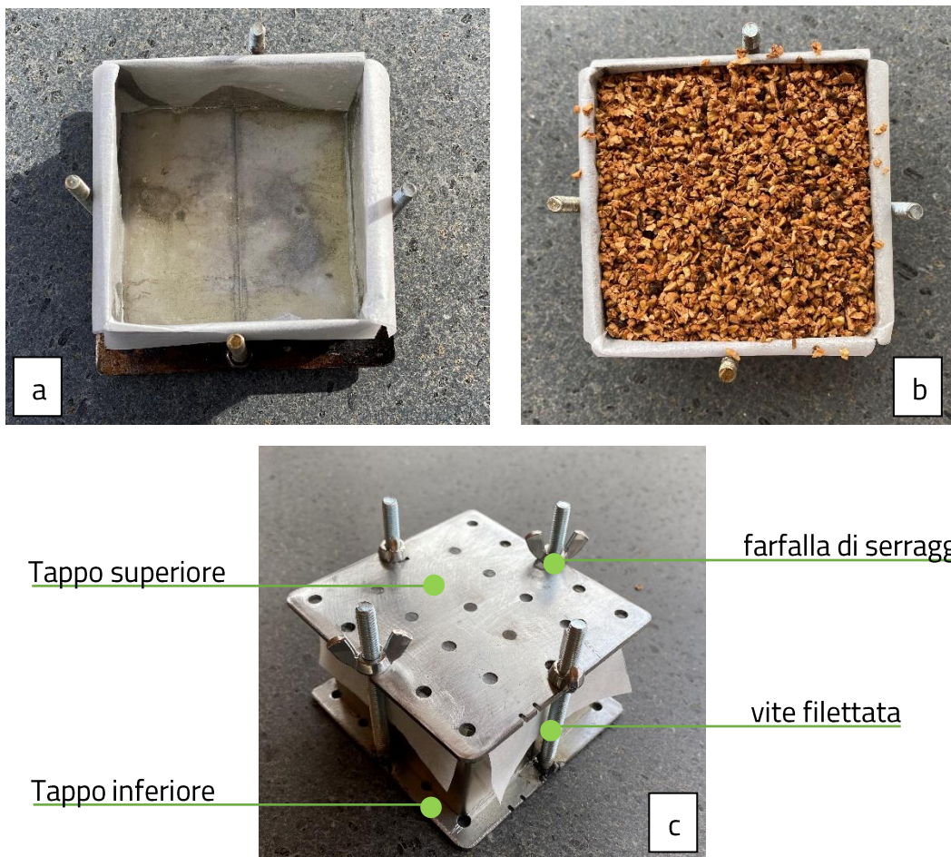
Figura 45 - Fasi di preparazione delle forme metalliche per l'inserimento nella camera riscaldante: a) disposizione del tappo inferiore e rivestimento; b) versamento della miscela; c) chiusura e serraggio del tappo superiore
