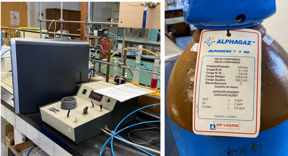
Figura 42 – Picnometro e dati tecnici dell'elio utilizzato per la prova
