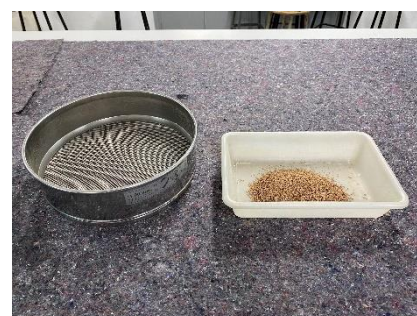
Figura 40 – Fasi del procedimento di determinazione della curva granulometrica dei materiali
