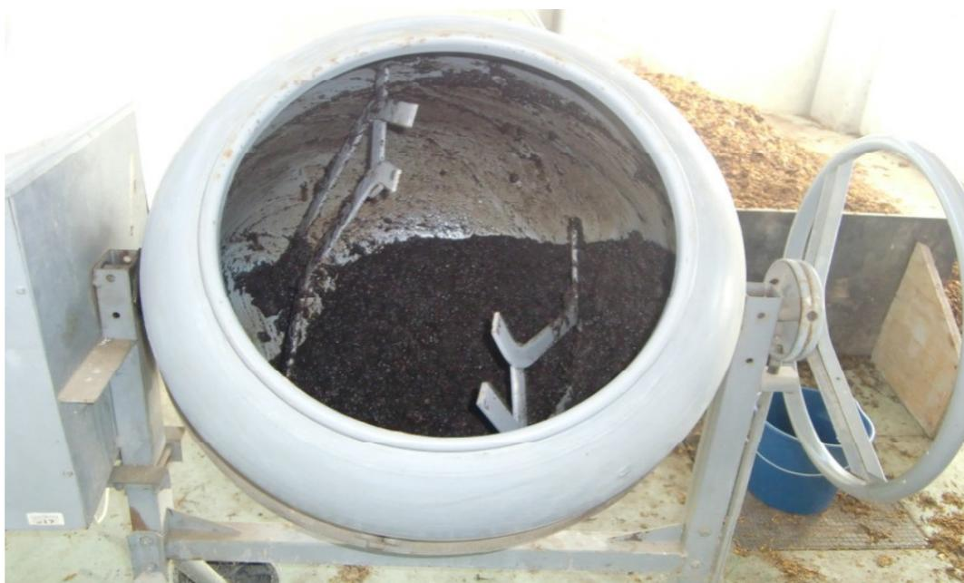
*Foto 4 – Lavaggio del compost all'interno di una betoniera.*
