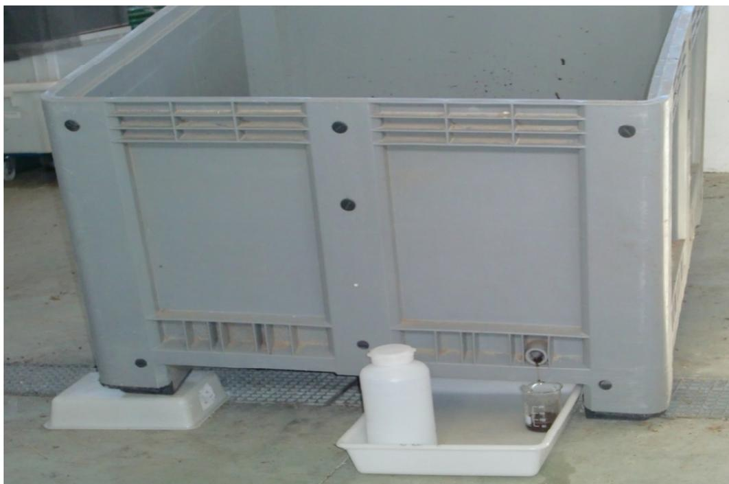
*Foto 5 – Filtrazione del compost sottoposto a lavaggio.*
