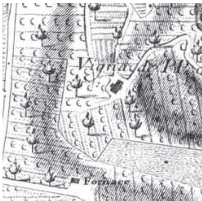
38/ Particolare della Nuova Pianta di Nolli. Si noti la convenzione grafica impiegata per indicare l'orografia del terreno
