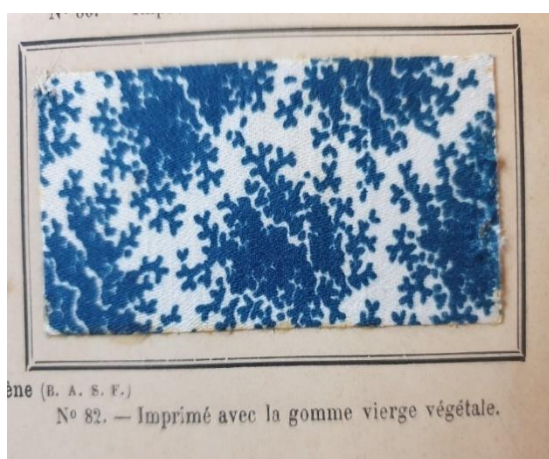
Figure 3.1: sample picture of Bleu méthylène-Imprimé avec la gomme végétale, produced by (B.A.S.F.)
