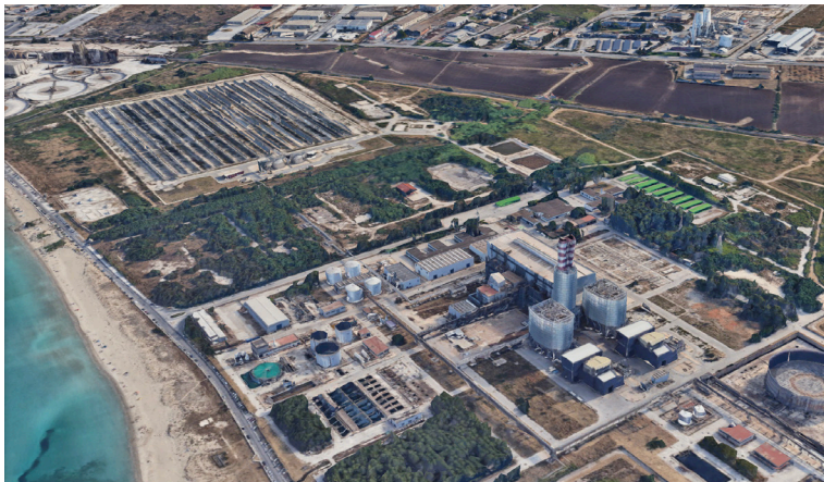
Fig. 4. Fotogramma da Google Earth della centrale Enel Archimede di Priolo Gargallo. Nell'immagine è visibile l'impianto a ciclo combinato (a destra) e il campo a collettori solari (a sinistra).
