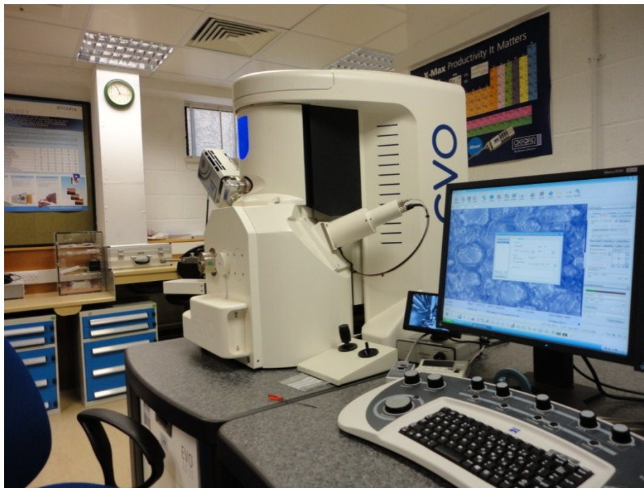
Figura H.64: Microscopio ESEM Carl Zeiss EVO LS15 utilizzato per la scansione delle superfici dei provini di schiuma sintattica
