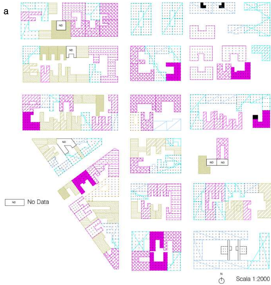
Figura 8.6 | Categorie tipologico-strutturali delle 164 unità edilizie presenti nell'area indagata: a) Schema planimetrico delle 17 categorie tipologico-strutturali individuate; b) Legenda.
