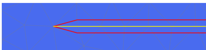
FIG. 3. 22 – Particolare della mesh in cui è non stata prolungata l'interfaccia.
