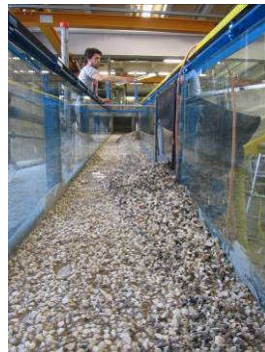
Figura 6.73 Vista generale dei depositi lungo la canaletta A in condizioni drenate relativi alla prova sperimentale n. 13 ad esperimento concluso.
