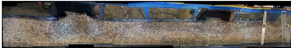
Figura 6.7 Depositi in condizioni drenate relativi alla prova sperimentale n.2 ad esperimento concluso per l'intera estensione del canale A.
