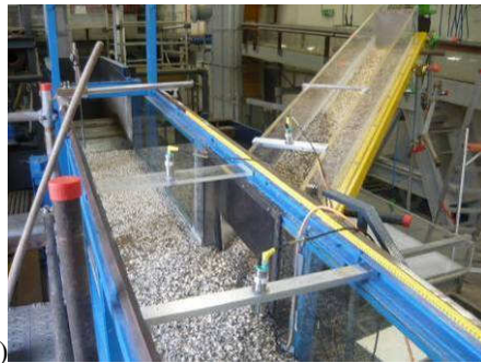
Figura 6.22 Depositi in condizioni drenate relativi alla prova sperimentale n.4 ad esperimento concluso: a) vista della canaletta B; b) vista dall'alto della canaletta A in corrispondenza della sezione di sbocco della canaletta B.
