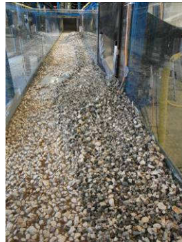
Figura 6.48 Vista generale dei depositi lungo la canaletta A in condizioni drenate relativi alla prova sperimentale n.9 ad esperimento concluso.
