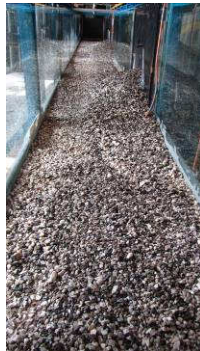
Figura 6.83 Vista generale dei depositi lungo la canaletta A in condizioni drenate relativi alla prova sperimentale n.15 ad esperimento concluso.
