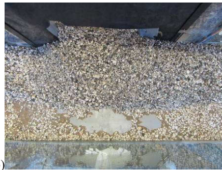
Figura 6.57 Depositi in condizioni drenate relativi alla prova sperimentale n.10 ad esperimento concluso: a) vista della canaletta C; b) vista dall'alto della canaletta A in corrispondenza della sezione di sbocco della canaletta C.
