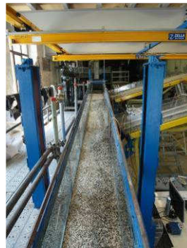
Figura 6.89 Vista generale dei depositi lungo la canaletta A in condizioni drenate relativi alla prova sperimentale n.16 ad esperimento concluso.
