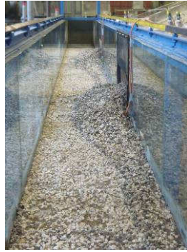
Figura 6.21 Vista generale dei depositi lungo la canaletta A in condizioni drenate relativi alla prova sperimentale n.4 ad esperimento concluso.
