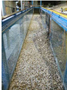
Figura 6.42 Vista generale dei depositi lungo la canaletta A in condizioni drenate relativi alla prova sperimentale n.8 ad esperimento concluso.
