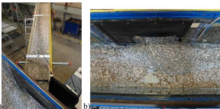
Figura 6.35 Depositi in condizioni drenate relativi alla prova sperimentale n.6 ad esperimento concluso: a) vista della canaletta C; b) vista dall'alto della canaletta A in corrispondenza della sezione di sbocco della canaletta C.
