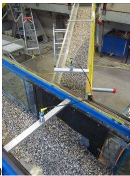
Figura 6.57 Depositi in condizioni drenate relativi alla prova sperimentale n.10 ad esperimento concluso: a) vista della canaletta C; b) vista dall'alto della canaletta A in corrispondenza della sezione di sbocco della canaletta C.
