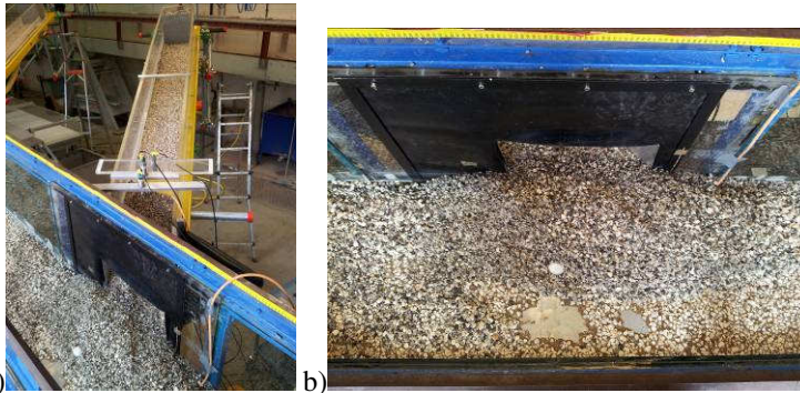
Figura 6.29 Depositi in condizioni drenate relativi alla prova sperimentale n.5 ad esperimento concluso: a) vista della canaletta C; b) vista dall'alto della canaletta A in corrispondenza della sezione di sbocco della canaletta C.
