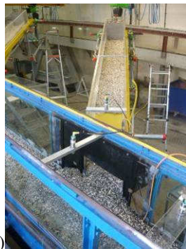
Figura 6.23 Depositi in condizioni drenate relativi alla prova sperimentale n.4 ad esperimento concluso: a) vista della canaletta C; b) vista dall'alto della canaletta A in corrispondenza della sezione di sbocco della canaletta C.
