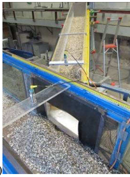
Figura 6.56 Depositi in condizioni drenate relativi alla prova sperimentale n.10 ad esperimento concluso: a) vista della canaletta B; b) vista dall'alto della canaletta A in corrispondenza della sezione di sbocco della canaletta B.
