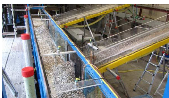
Figura 6.101 Vista generale dei depositi lungo la canaletta A in condizioni drenate relativi alla prova sperimentale n. 18 ad esperimento concluso.
