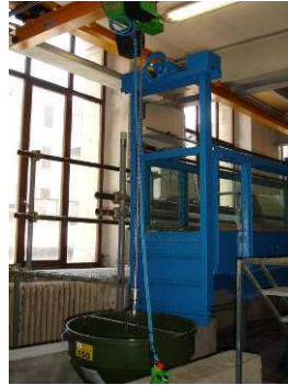
Figura 5.6 Sistema carroponete e paranco a cui è attaccata la benna utilizzata come contenitore per il ghiaino da movimentare.
