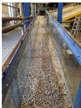
Figura 6.14 Vista generale dei depositi lungo la canaletta A in condizioni drenate relativi alla prova sperimentale n.3 ad esperimento concluso.
