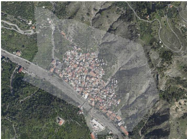
Figura 4.19 Rappresentazione grafica della area alluvionale simulata tramite FLO-2D, tramite una maglia 5x5m.
