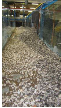
Figura 6.55 Vista generale dei depositi lungo la canaletta A in condizioni drenate relativi alla prova sperimentale n.10 ad esperimento concluso.
