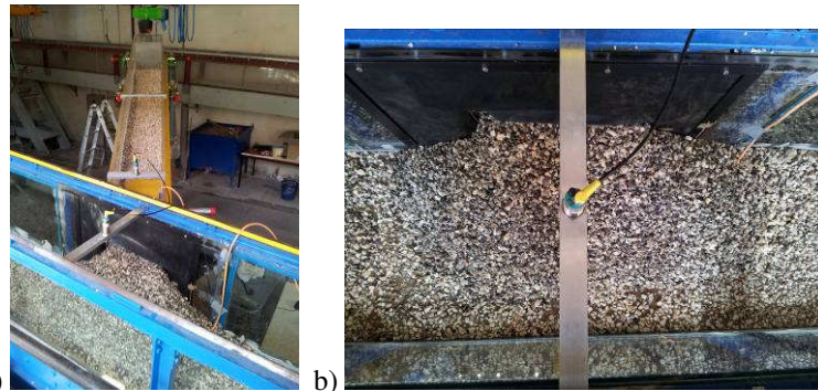
Figura 6.3 Depositi in condizioni drenate relativi alla prova sperimentale n.1 ad esperimento concluso: a) vista della canaletta C; b) vista dall'alto della canaletta A in corrispondenza della sezione di sbocco della canaletta C.
