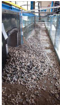
Figura 6.107 Vista generale dei depositi lungo la canaletta A in condizioni drenate relativi alla prova sperimentale n.19 ad esperimento concluso.
