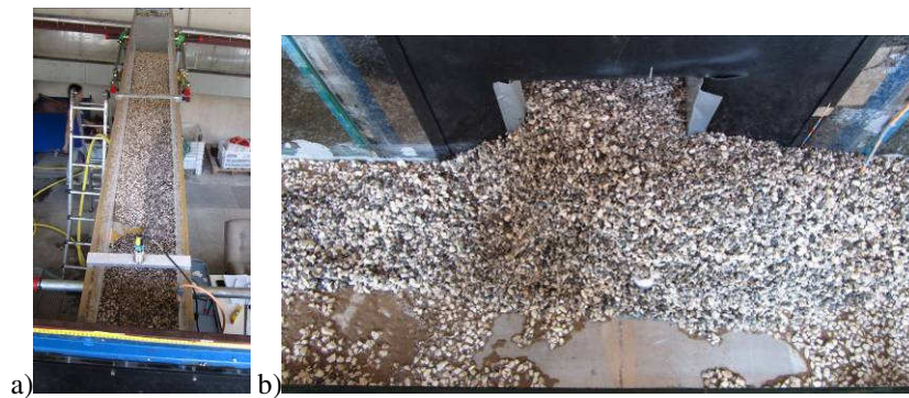
Figura 6.109 Depositi in condizioni drenate relativi alla prova sperimentale n.19 ad esperimento concluso: a) vista della canaletta C; b) vista dall'alto della canaletta A in corrispondenza della sezione di sbocco della canaletta C.
