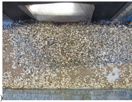
Figura 6.56 Depositi in condizioni drenate relativi alla prova sperimentale n.10 ad esperimento concluso: a) vista della canaletta B; b) vista dall'alto della canaletta A in corrispondenza della sezione di sbocco della canaletta B.
