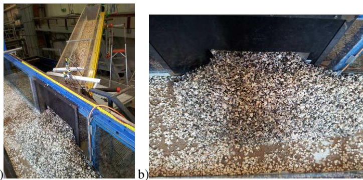
Figura 6.28 Depositi in condizioni drenate relativi alla prova sperimentale n.5 ad esperimento concluso: a) vista della canaletta B; b) vista dall'alto della canaletta A in corrispondenza della sezione di sbocco della canaletta B.
