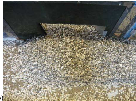
Figura 6.22 Depositi in condizioni drenate relativi alla prova sperimentale n.4 ad esperimento concluso: a) vista della canaletta B; b) vista dall'alto della canaletta A in corrispondenza della sezione di sbocco della canaletta B.
