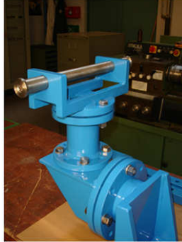
Figura 5.4 Particolare della cerniera di collegamento delle canalette laterali (canale B e canale C) alla canaletta principale (canale A), che consente la variazione dell'angolo di confluenza e della pendenza delle canalette laterali.
