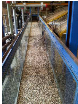
Figura 6.27 Vista generale dei depositi lungo la canaletta A in condizioni drenate relativi alla prova sperimentale n.5 ad esperimento concluso.
