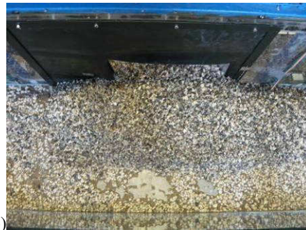
Figura 6.23 Depositi in condizioni drenate relativi alla prova sperimentale n.4 ad esperimento concluso: a) vista della canaletta C; b) vista dall'alto della canaletta A in corrispondenza della sezione di sbocco della canaletta C.
