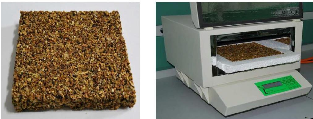
Figura 9 Immagine del pannello ottenuto dai sottoprodotti di potatura dell'Opuntia Ficus Indica [141]
