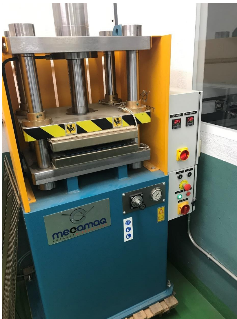
Figura 29 Pressa a caldo per esecuzione campioni
