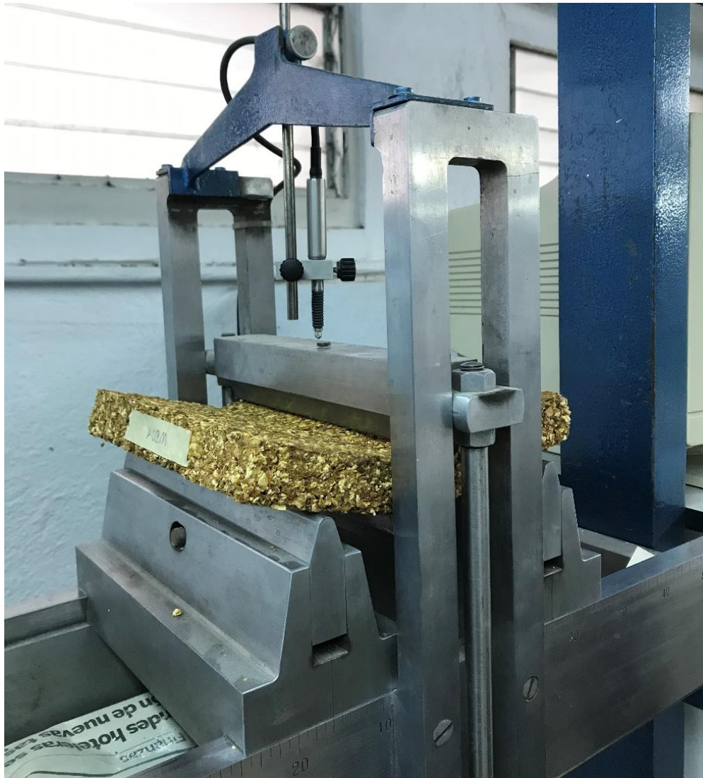
Figura 36 Test rottura dei campioni a tre punti per la determinazione della resistenza a flessione
