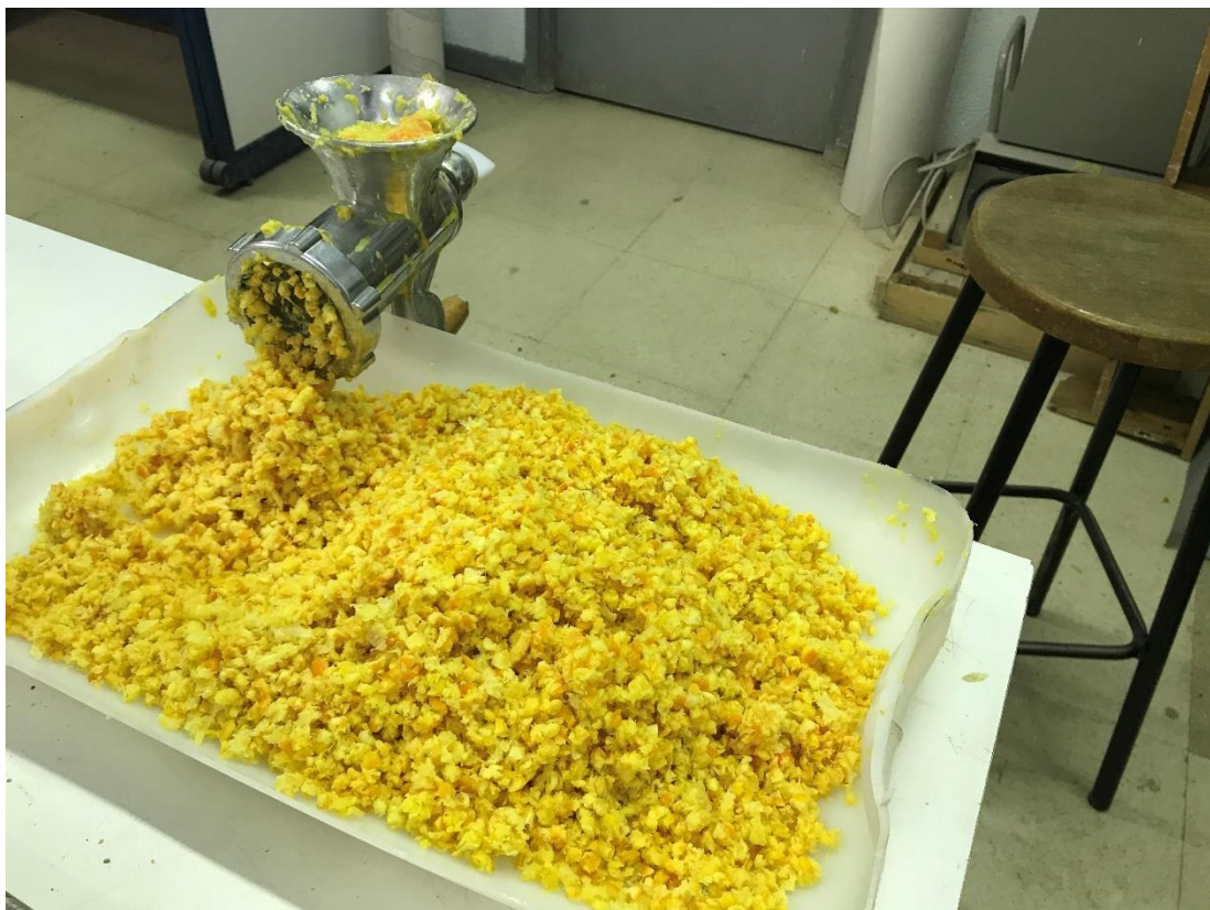
Figura 17 Triturazione del sottoprodotto di arance tramite mulino manuale
