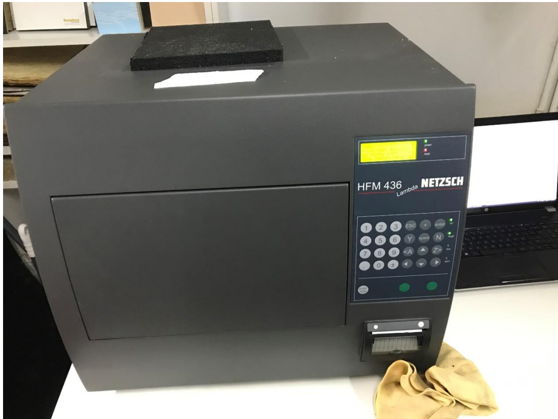
Figura 34 Apparecchio per il calcolo della conducibilità termica con il metodo delle piastre riscaldate, modello Netzsch HFM 436 Lambda,
