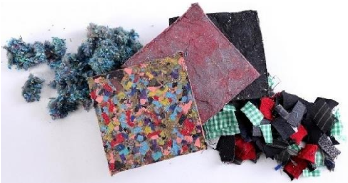
Figura 3 Pannelli realizzati da scarti di fibre tessili presso l'UNSW Centre for Sustainable Materials Research and Technology (SMaRT)
