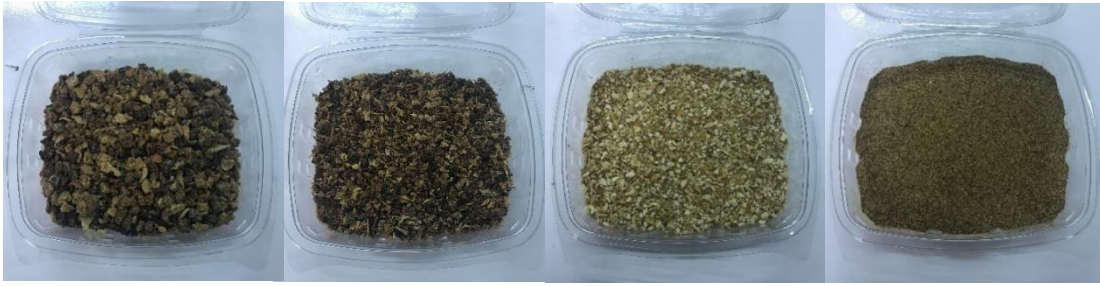
Figura 20 Granulometrie di scarti delle arance essiccate e setacciate, dal tipo d > 6 mm (a sinistra) al tipo d < 0,65 mm (a destra).
