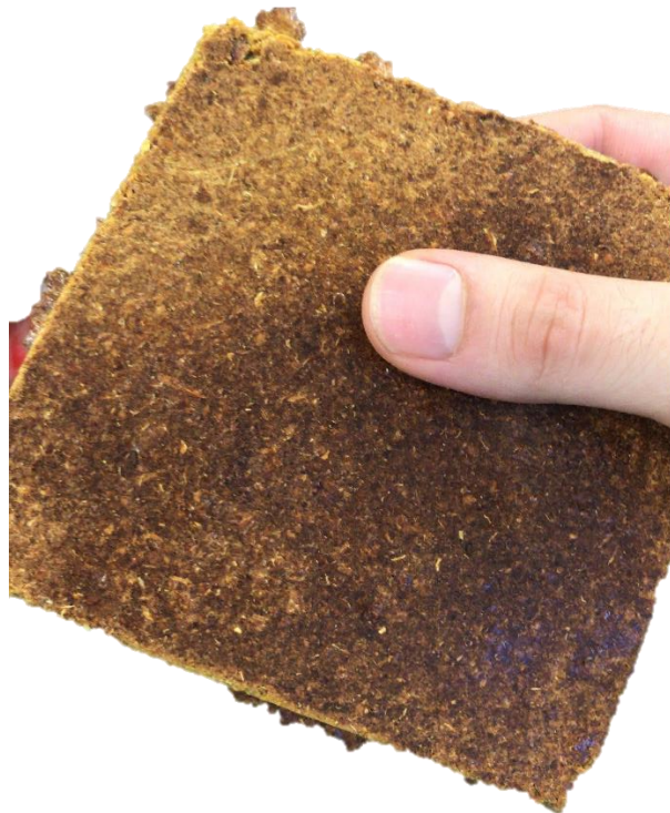
Figura 30 Campione ottenuto da pressatura con piastre calde
