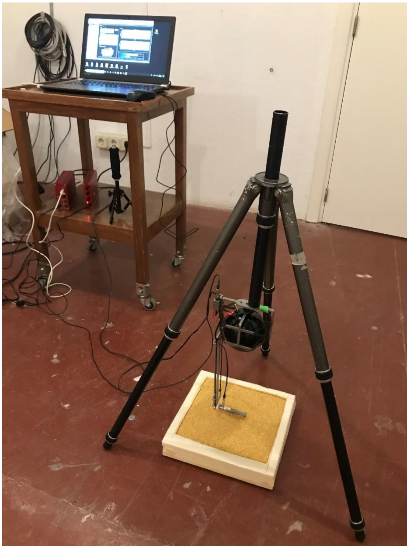
Figura 37 Misurazione del coefficiente di assorbimento acustico su campione in granuli.
