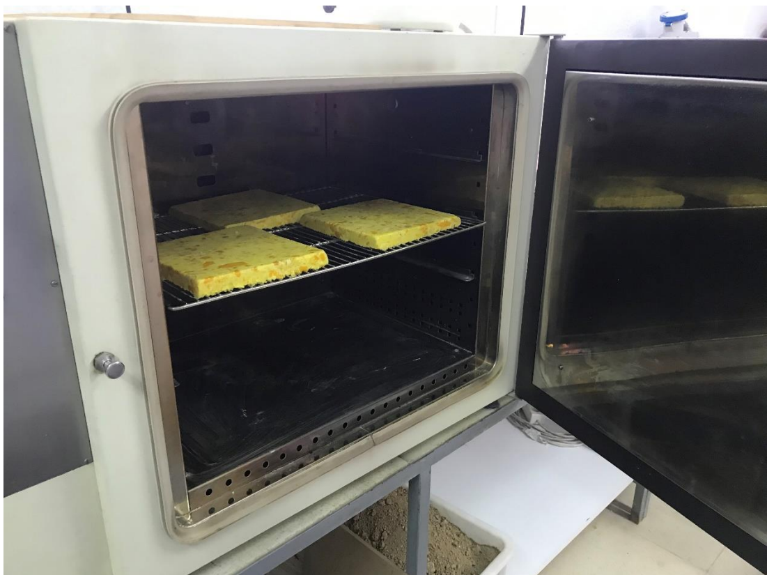
Figura 24 Essiccazione dei campioni pressati a freddo
