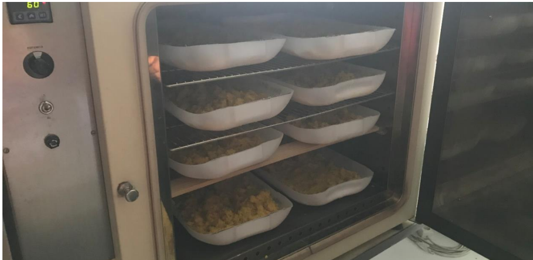
Figura 19 Essiccazione scarti di agrumi tritati.
