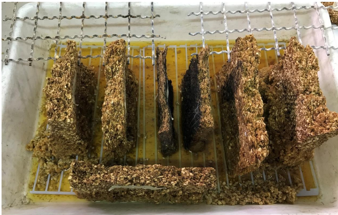
Figura 38 Immagine del test assorbimento d'acqua su un lato dei campioni
