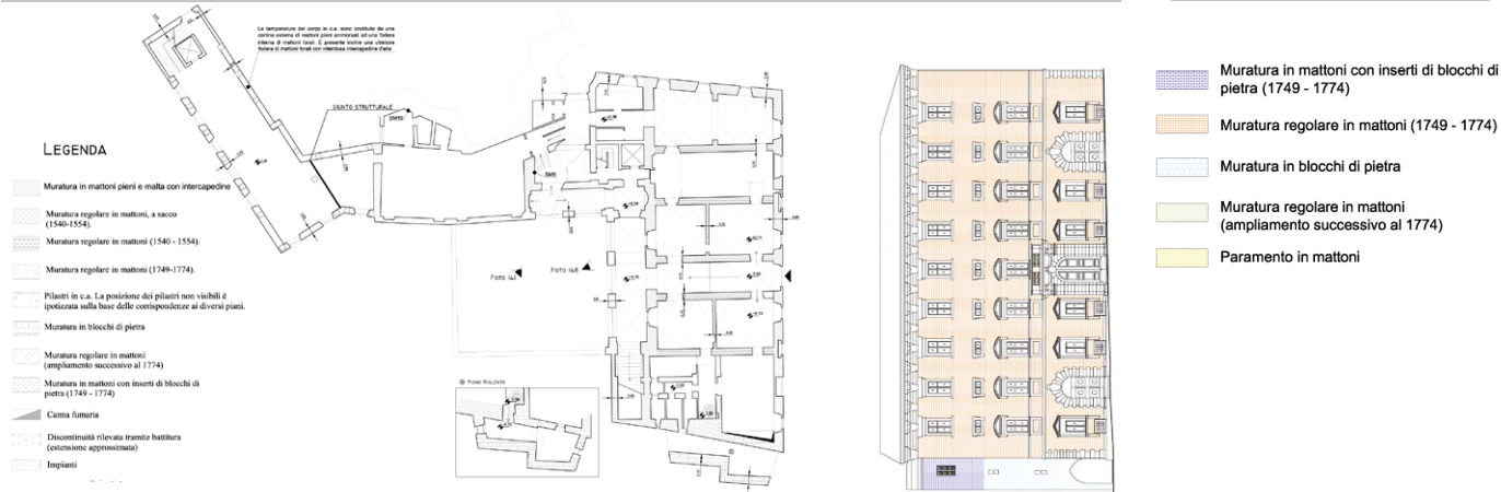
4. Rilievo materico-costruttivo e quadro fessurativo
