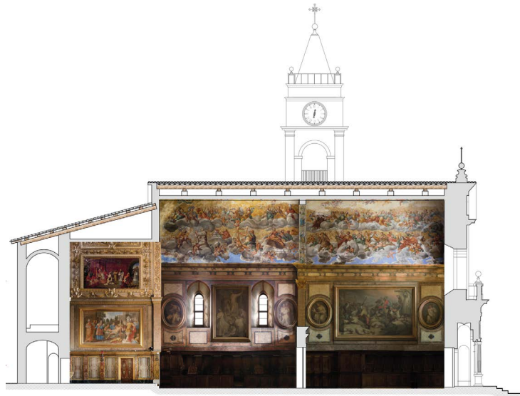
3. Rilievo materico-costruttivo e quadro fessurativo
