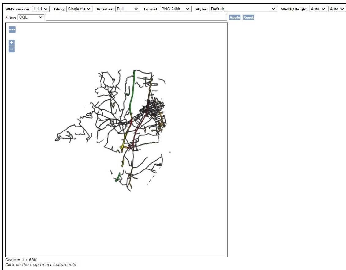
Fig. 9.18 - Anteprima OpenLayers visualizzata su browser Google Chrome in risposta alla richiesta GetMap elencata precedentemente.
