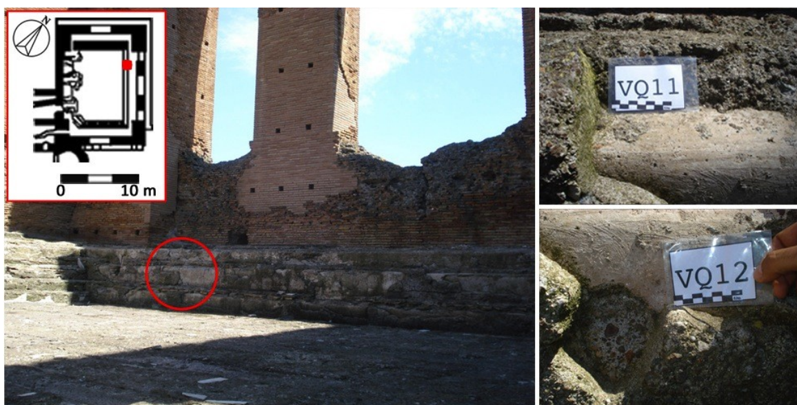
Figura 27. A sinistra foto dell'area termale del Calidarium e particolari (a destra) delle aree interessate dal prelievo dei campioni VQ11 e VQ12.
