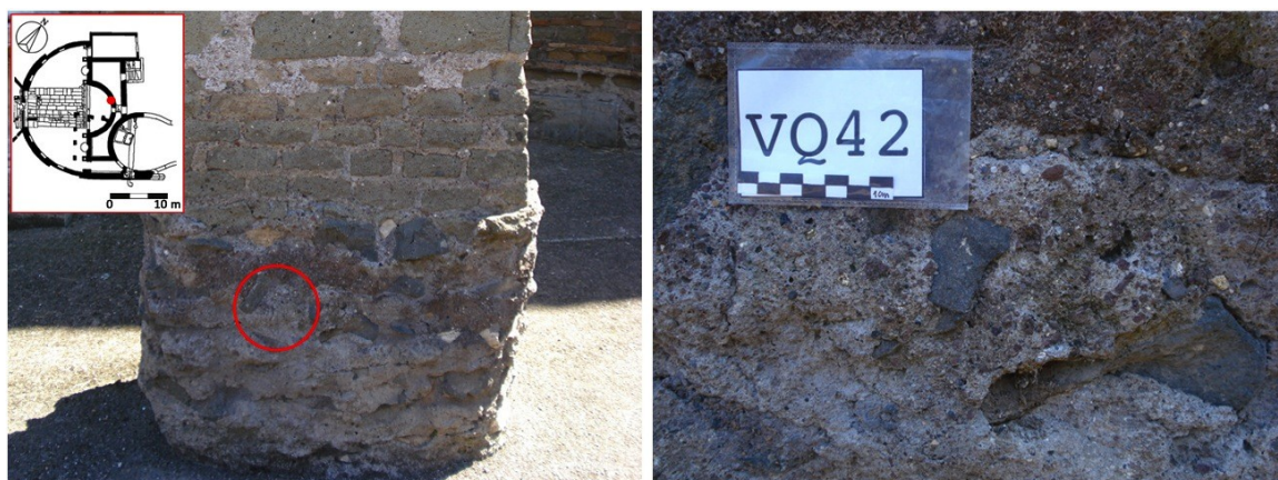
Figura 23. A sinistra foto della colonna dalla quale è stato prelevato il campione VQ42 (foto a destra).
