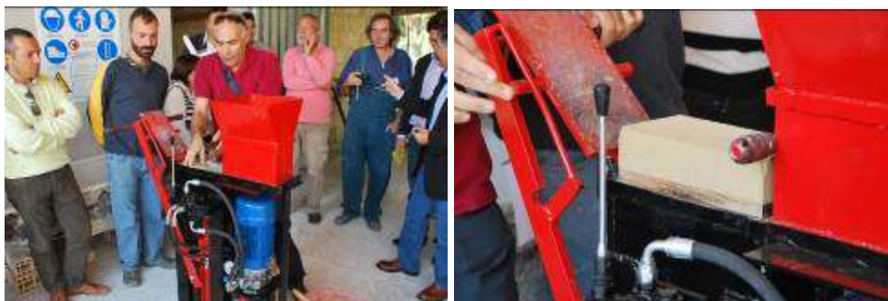
Figg. Ente Scuola Edile di Chieti: Dimostrazione pratica della realizzazione di un mattone in terra pressata, arch. Jilani Khaldi.
