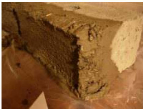
Immagini della prova: provini della serie 1 e della serie 2. Da sinistra in alto: misurazioni intermedie dopo 2h; condizioni della base del campione dopo 12 ore di immersione.
