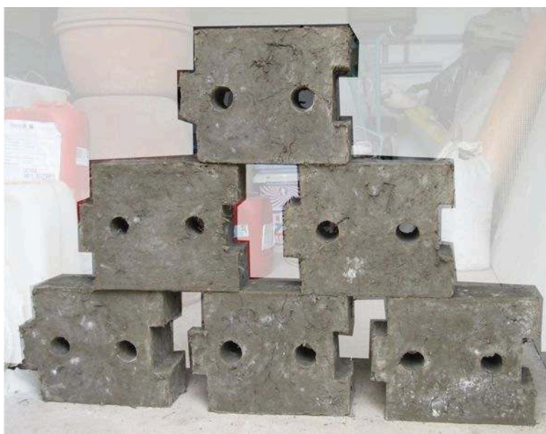
Fig. 83, Blocchi in terra cruda realizzati.
