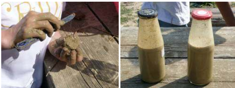
Figg. Il laboratorio dell'associazione Terrae Onlus: prove rudimentali per il riconoscimento della terra. Foto di Elena Bignamini
