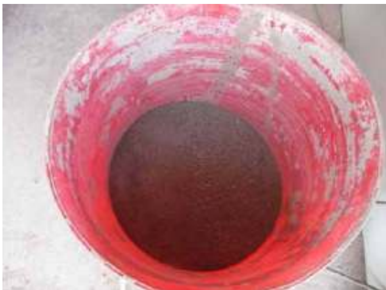
Fig. 78, Sabbia vulcanica – azolo, impiegato per il confezionamento dell'impasto per la produzione dei blocchi in terra cruda
