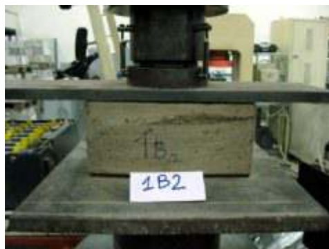
Immagini della prova, provini della serie 1 e della serie 2. Da sinistra in alto: Prove sui campioni, alternativamente, prima e dopo il test di compressione; campioni dopo la prova.
