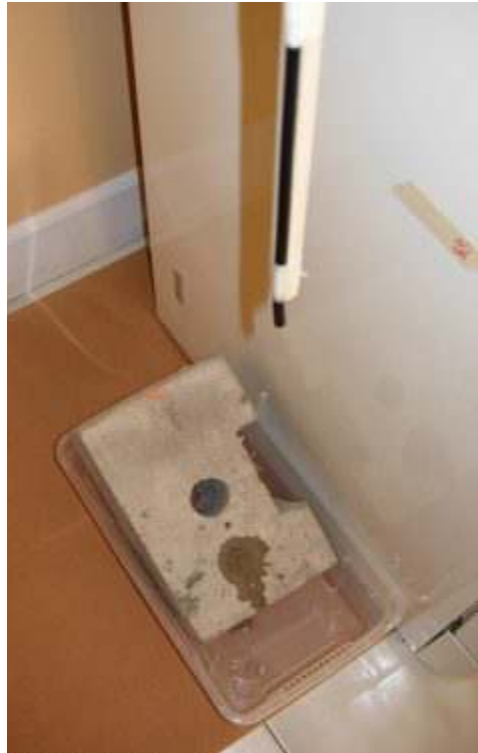
Immagini della prova: provini della serie 2 e della serie 3. Da sinistra in alto: Il dispositivo di Geelong, composto dal contenitore graduato, il tubo da 4mm e il campione nella vaschetta, posto ad una distanza di 40 cm; posizione del campione; condizioni del campione dopo lo sgocciolamento dei 100 ml previsti in un ora; particolari del contenitore graduato.
