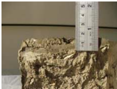
Immagini della prova: provini della serie 3 e della serie 4. Da sinistra in alto: rottura del campione con la scure; condizioni del campione dopo la prova e la rottura; misurazioni della profondità D e della penetrazione dell'umidità U.
