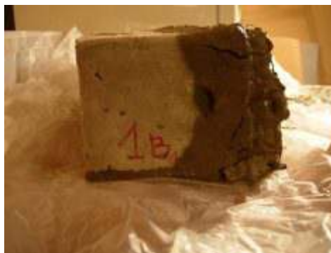
Immagini della prova: provini della serie 1 e della serie 2. Da sinistra in alto: misurazioni intermedie dopo 2h; condizioni della base del campione dopo 12 ore di immersione.
