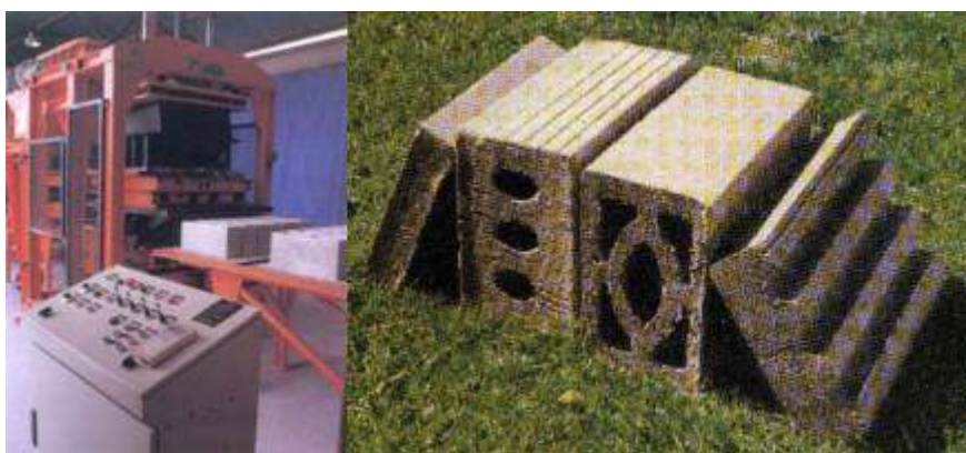
Fig. 51, mattoni trafilati in terra cruda
