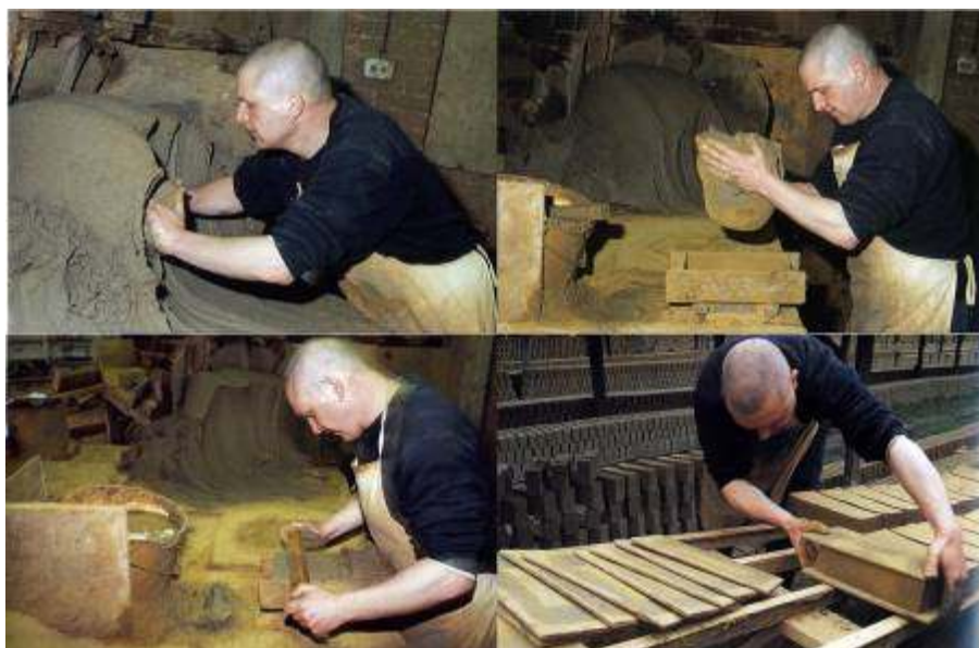
Fig. 49, preparazione dei mattoni crudi, Blumer Brickworks, Suffolk, Inghilterra
