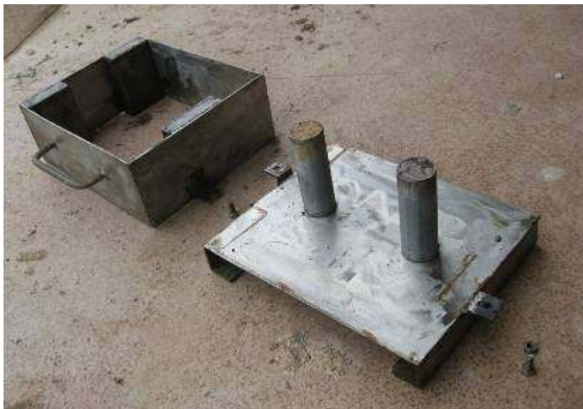
Fig. 77, La cassaforma in acciaio con il fondo rimovibile
