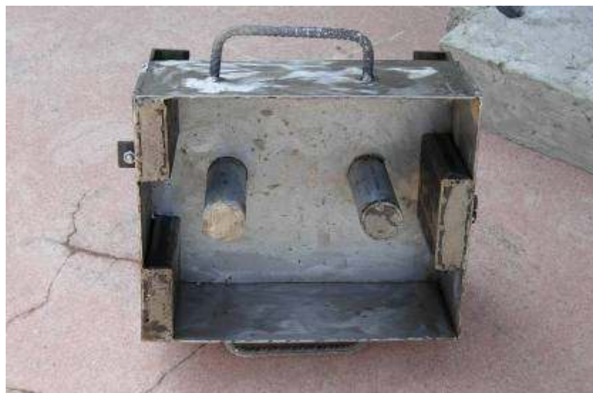
Fig. 76, La cassaforma in acciaio per la formatura del blocco in terra del tipo A.
