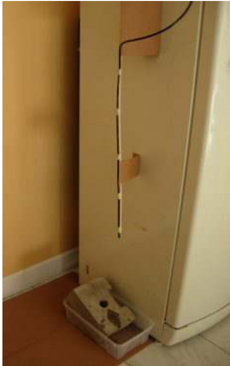
Immagini della prova: provini della serie 2 e della serie 3. Da sinistra in alto: Il dispositivo di Geelong, composto dal contenitore graduato, il tubo da 4mm e il campione nella vaschetta, posto ad una distanza di 40 cm; posizione del campione; condizioni del campione dopo lo sgocciolamento dei 100 ml previsti in un ora; particolari del contenitore graduato.
