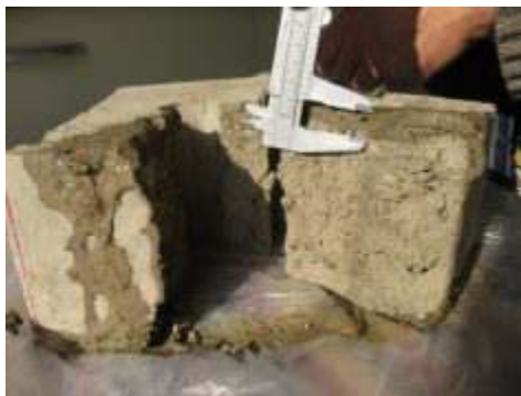
Immagini della prova: provini della serie 3 e della serie 4. Da sinistra in alto: rottura del campione con la scure; condizioni del campione dopo la prova e la rottura; misurazioni della profondità D e della penetrazione dell'umidità U.
