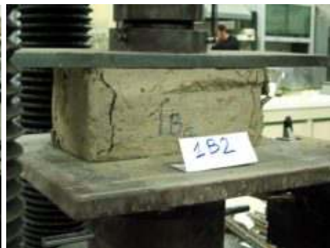
Immagini della prova, provini della serie 1 e della serie 2. Da sinistra in alto: Prove sui campioni, alternativamente, prima e dopo il test di compressione; campioni dopo la prova.
