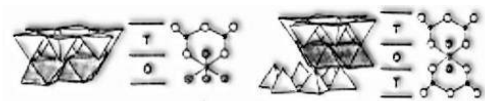
Fig. 41, strutture cristallografiche lamellare delle argille, successione di strati T (tetraedrici silicei) e strati O (ottaedrici alluminosi)
