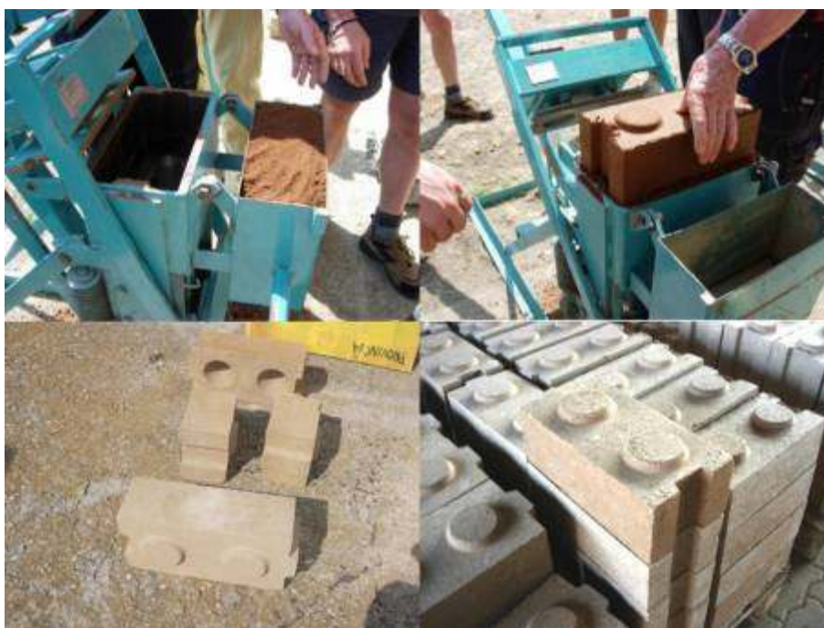
Fig. 53, produzione di blocchi compressi con la pressa Altech brevettata dal prof. Roberto Mattone
