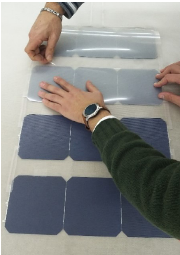
Fig. 5.8. Preparazione e processo di laminazione del pannello SLICE 2.0.1
