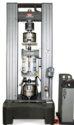
Fig. 4.3. Macchina di Trazione monoassiale INSTRON 5980 Series - 5982
