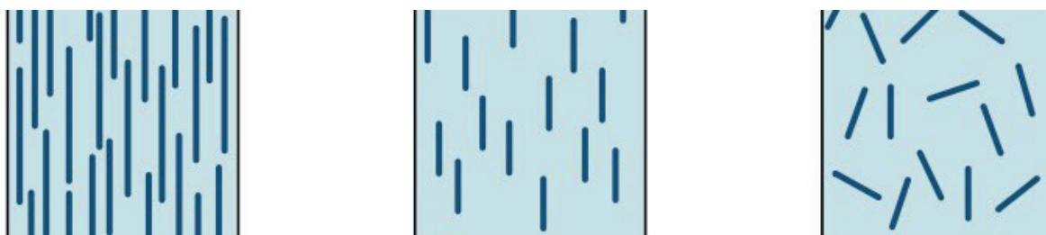
Fig. 3.4. Distribuzione delle fibre in compositi fibrosi. Fibre fibre continue (a sinistra), discontinue (al centro) o disperse in modo casuale (a destra)
