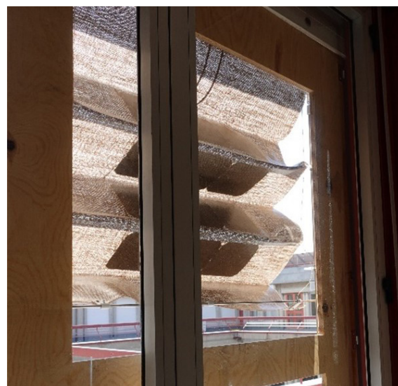
Fig. 5.25. Installazione del prototipo SLICE 2.0 sull'infixo per test in condizioni ambientali
