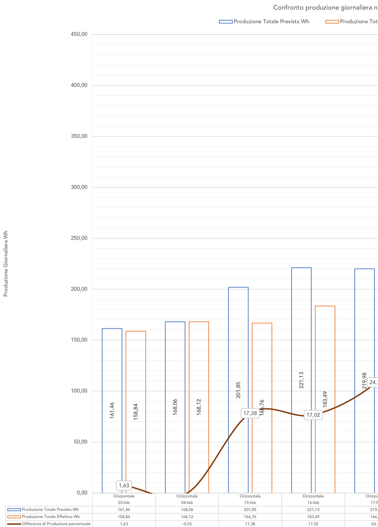
Fig. 5.37. Confronto tra la produzione effettiva (arancione) e la produzione prevista (blu) nell'arco di 4 ore in cui non risultavano ombreggiamenti, con differenza della produzione percentuale (rosso)
