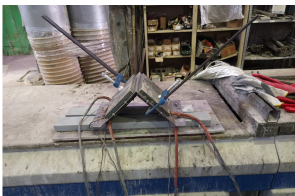
Fig. 4.9. A sinistra, stampo in lamiera per i campioni di dimensioni 20x40 cm durante le prove di termoformatura. A destra, risultato della piega ottenuta su un campione di composito
