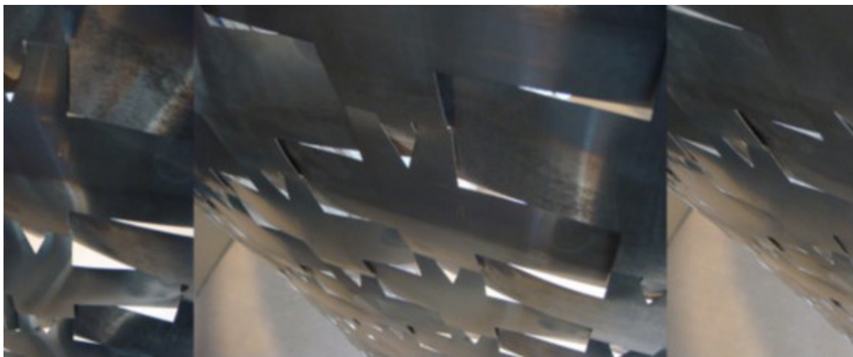
Fig. 2.14. Smart Thermobimetal Self-Ventilating Skin. Deformazioni dei fogli laminati all'aumentare della temperatura, con espansioni differenti (Velikov and Geoffrey, 2012)
