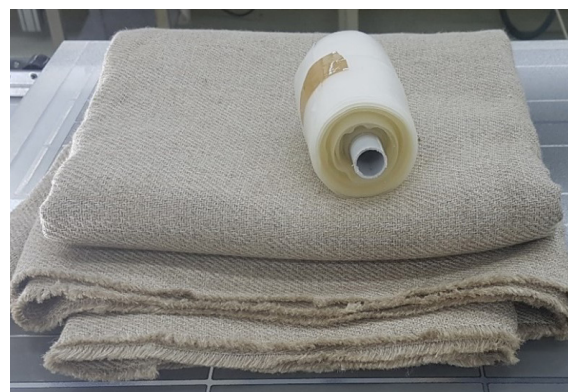
Fig. 4.1. Campioni di Biotex Flax 400 g/m 2 2x2 Twill e di SEBS prima della laminazione
