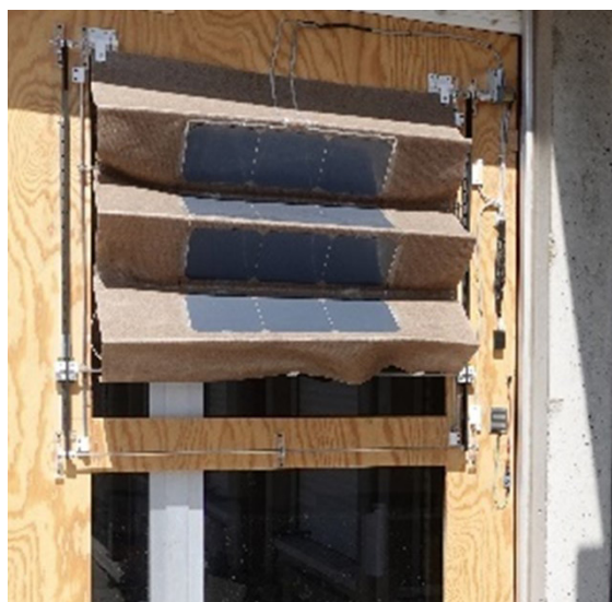
Fig. 5.25. Installazione del prototipo SLICE 2.0 sull'infixo per test in condizioni ambientali
