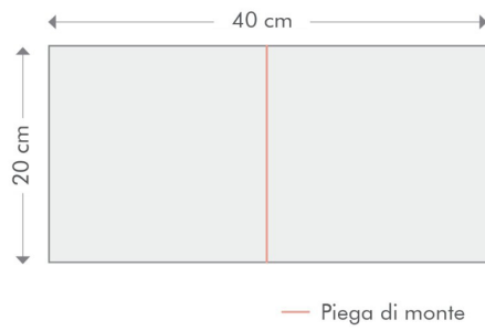
Fig. 4.6. Disegno per la pre-piegatura del composito a piega singola
