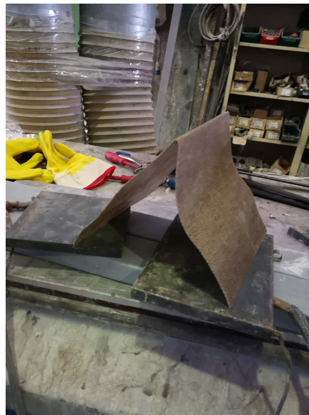
Fig. 4.9. A sinistra, stampo in lamiera per i campioni di dimensioni 20x40 cm durante le prove di termoformatura. A destra, risultato della piega ottenuta su un campione di composito
