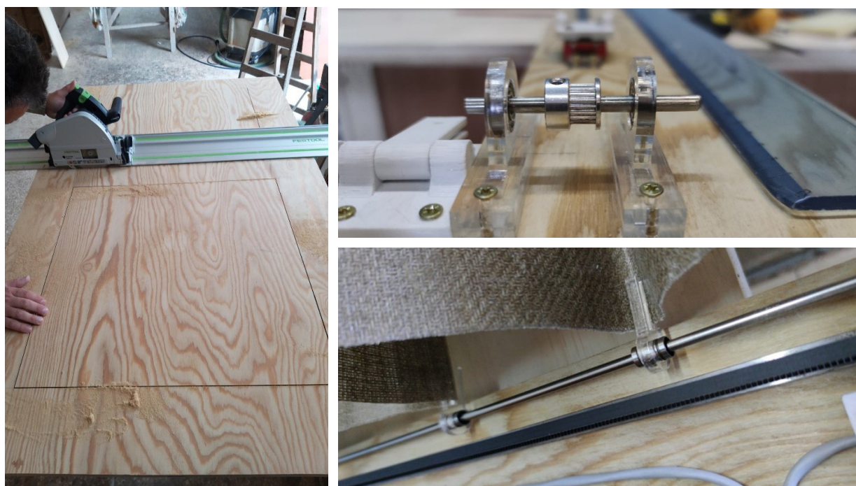
Fig. 4.22. A sinistra, preparazione del telaio in legno. In alta a destra, un dettaglio dei nuovi supporti per cuscinetti in plexiglass. In basso a destra, le nuove guide a scorrimento laterali con ganci a forchetta in plexiglass
