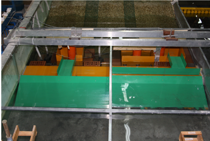
Figura 3.14: Modelli fisici impiegati nella campagna sperimentale nella configurazione smooth .
