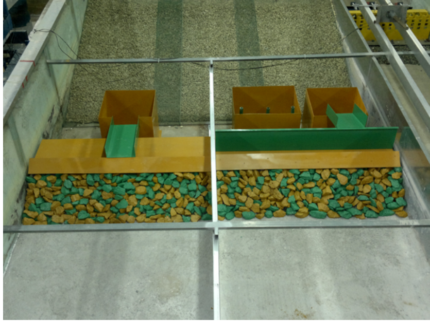
Figura 3.13: Modelli fisici impiegati nella campagna sperimentale nella configurazione rough .
