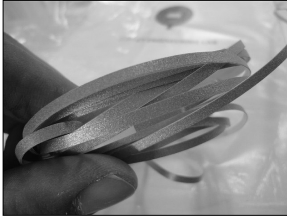
Figura H.22: materiale riflettente utilizzato come target per estensometro laser
