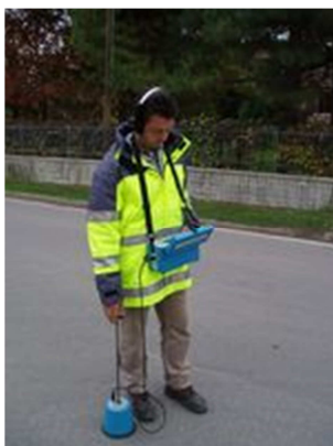
Figura 2.4: Operatore con geofono per la ricerca perdite idriche (TecnoMB s.r.l.)
