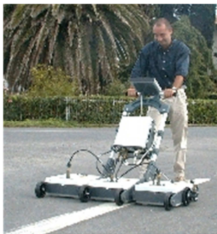
Figura 2.9: Operatore con Georadar multiantenna (IDS - Ingegneria Di Sistemi S.p.A.)
