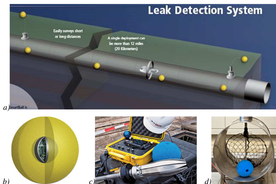
Figura 2.8: Sistema di individuazione acustico delle perdite SmartBall®: a) schema di funzionamento, b) sfera in gommapiuma con componenti all'interno, c) strumento di inserimento in condotta, d) strumento di recupero della sfera (Pure Technologies)
