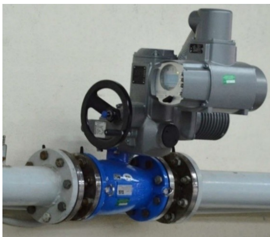
Figura 5.5 Valvola a fuso T.I.S. con attuatore AUMA installata in laboratorio
