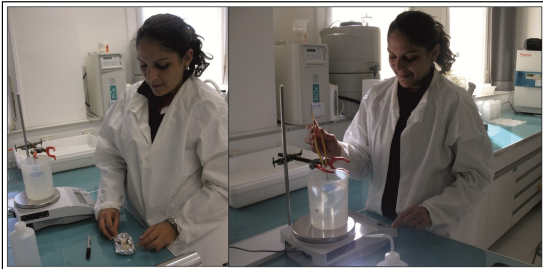
Fig. 86- Misura della densità dei campioni.
