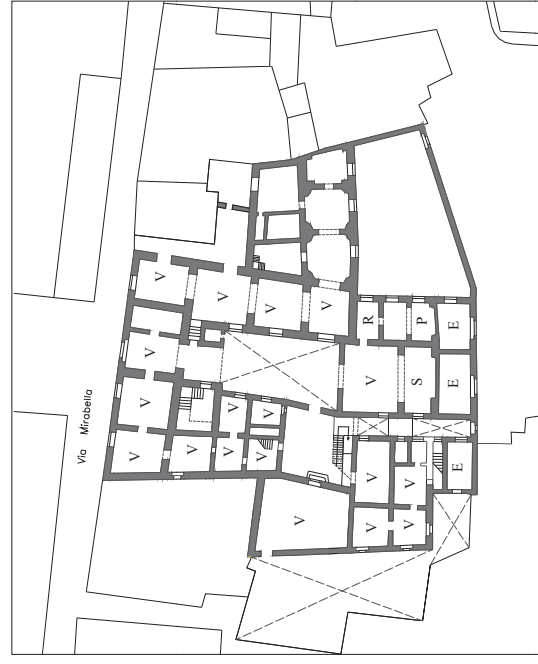
Fig. 9 - Palazzo Gargallo al Carmine. Ipotesi di ricostruzione. piano terra (pianta PPO) Legenda : E magazzini; P pagliera; S scuderia; R rimessa; V vani
