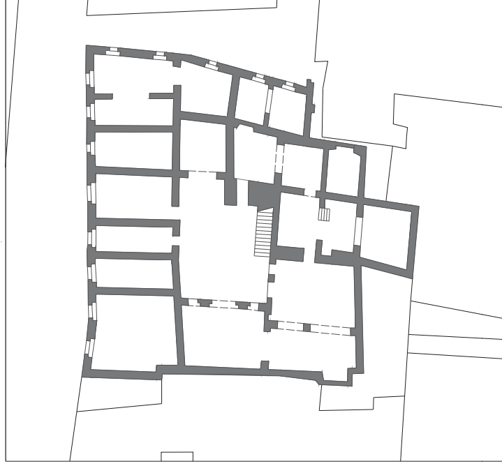
piano terra del palazzo Gargallo-Zappata (pianta PPO)
