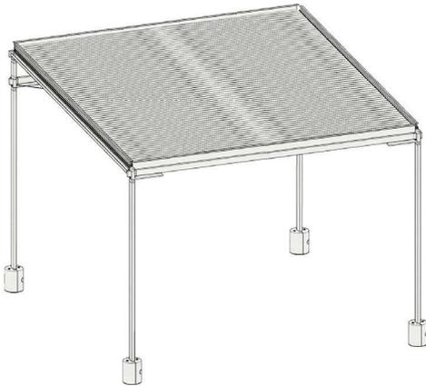
Fig. 4.19 | Modulo di copertura per la protezione durante la fase di scavo
