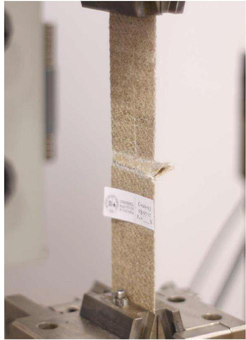
Fig. 5.29 | T-peel test sulla giunzione cucita SEBS-Biotex
