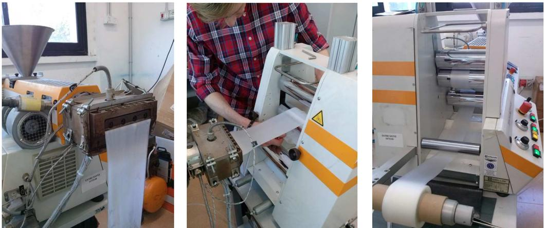
Fig. 4.3 | Il processo per ottenere il film sottile di SEBS
