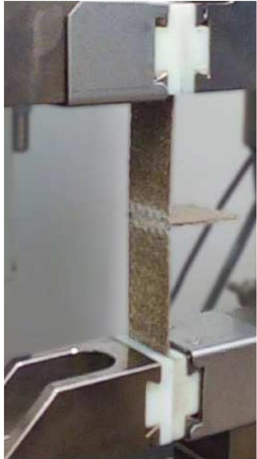
Fig. 5.21 | Provetta di SEBS-Biotex sottoposta a T-peel test
