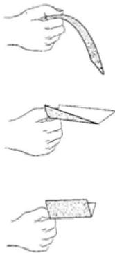
Fig. 2.13 | Resistenza per forma delle superfici piegate
