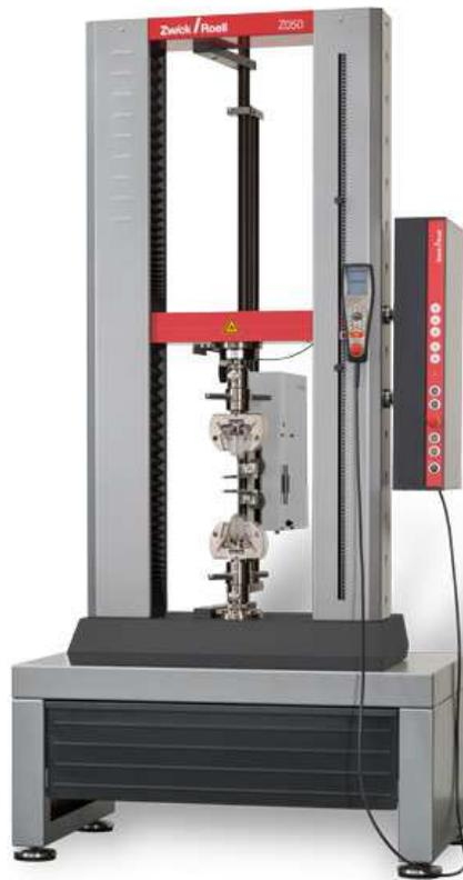
Fig. 4.8 | Macchina di trazione monoassiale Zwick-Roell modello z050
