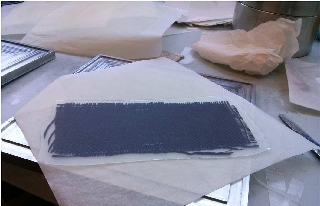
Fig. 4.7 | Opacizzazione della finitura della matrice in SEBS in campione di prova durante il settaggio dei parametri di produzione
