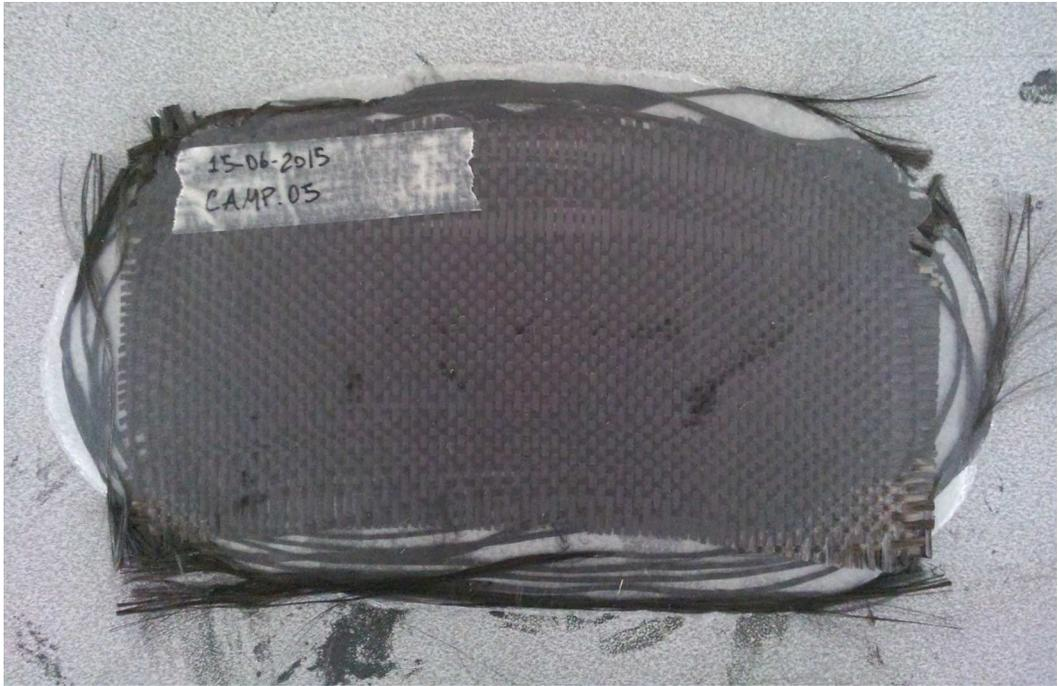
Fig. 4.6 | Delocalizzazione delle fibre di rinforzo in campione di prova durante il settaggio dei parametri di produzione
