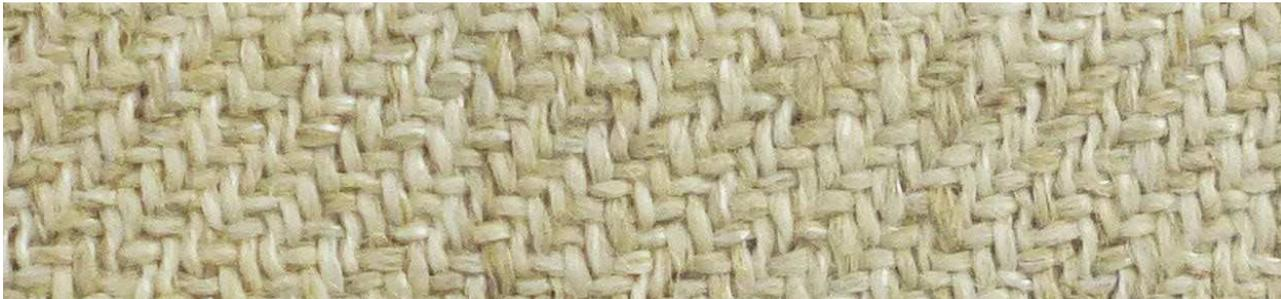
Fig. 4.4 | Tessuto di fibre di canapa prodotto da Composite Evolution - Biotex Flax 400 g/m<sup>2</sup> 2x2 Twill
