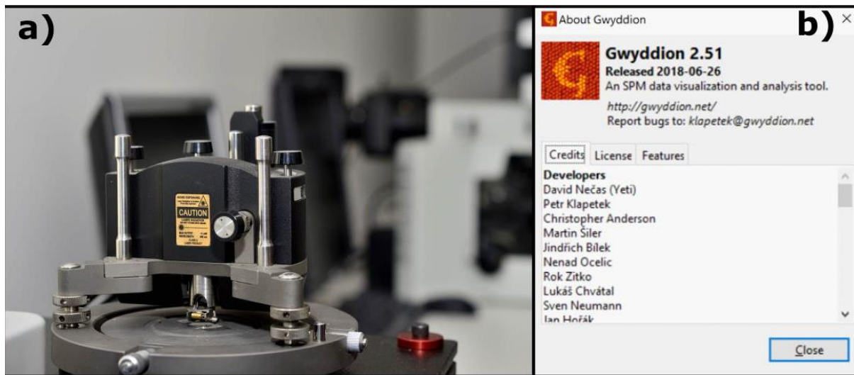
Figure 3.11: a) SMENA AFM and b) Gwyddion software [20]
