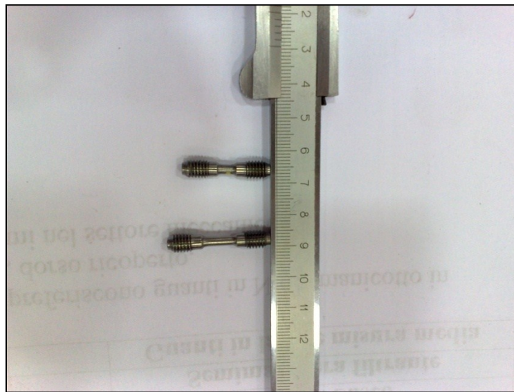
Figura C.2 - Provini per test ad elevata velocità di deformazione in tensione su Hopkinson Bar
