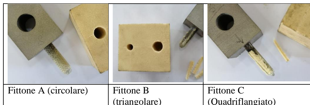
Figura 19 Foto dei provini dopo la prova di torsione
