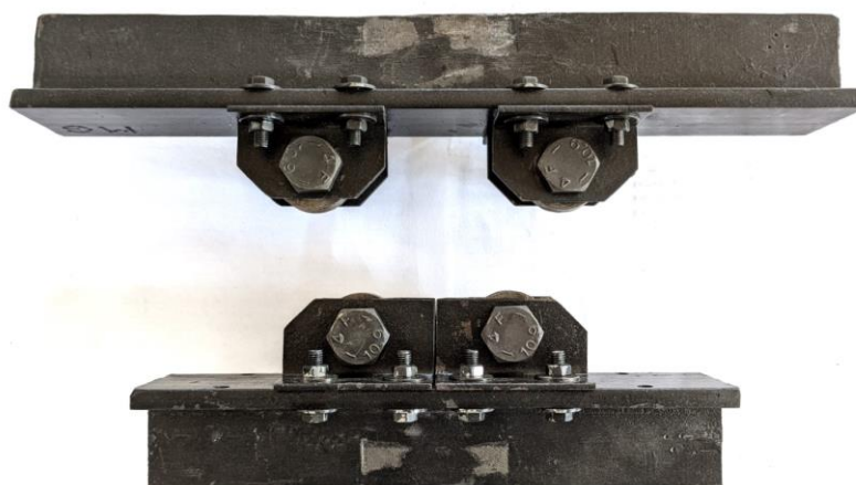
Figura 32 Castelletto realizzato per lo svolgimento della prova di flessione a quattro punti
