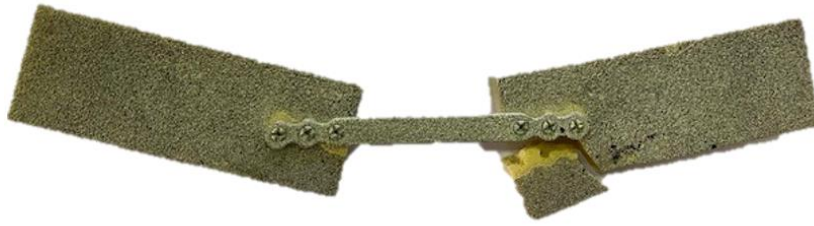
Figura 40 Immagine del provino dopo il fallimento del sistema
