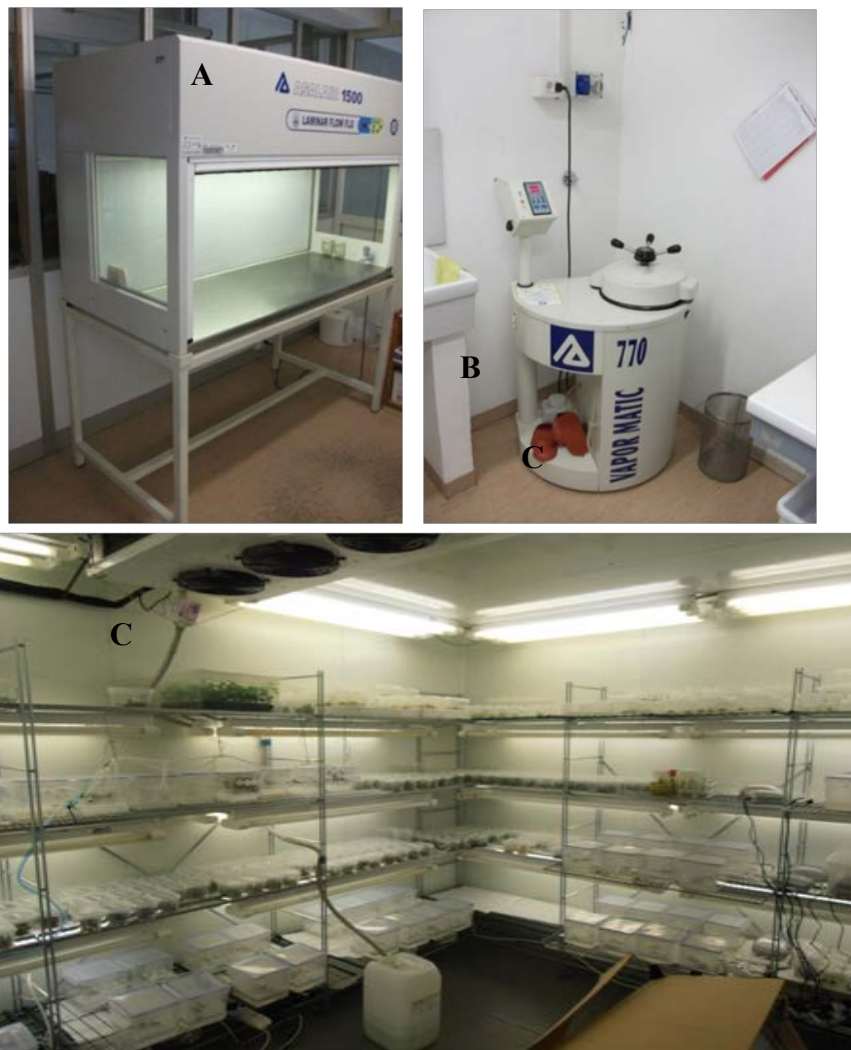
Figura 15 A: cappa a flusso laminare utilizzata durante la sperimentazione; B: Autoclave usata per la sterilizzazione delle attrezzature; C: interno della camera climatica.
