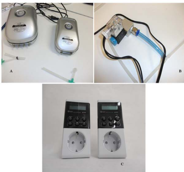
Figura 21 A: pompe per il funzionamento del sistema; B: elettrovalvola utilizzata per favorire la fuoriuscita di aria dal sistema; C: timer utilizzati per attivare il sistema.
