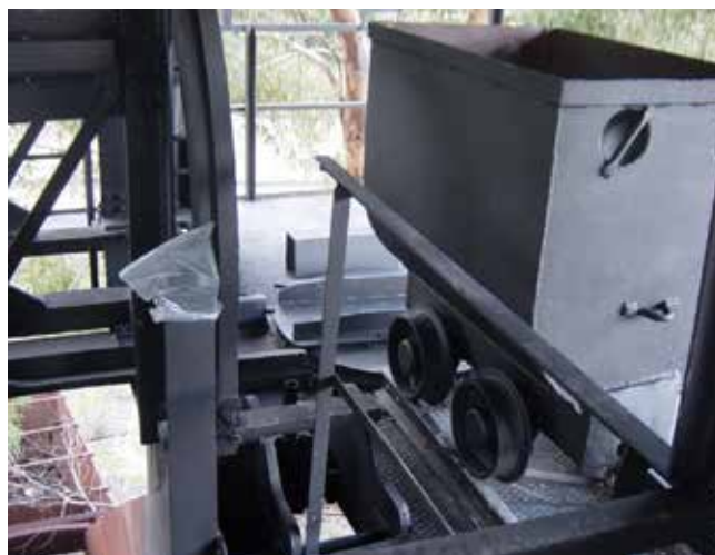
Fig. 15 B - Particolare della gabbia con un carrello. Pozzo n° 3
