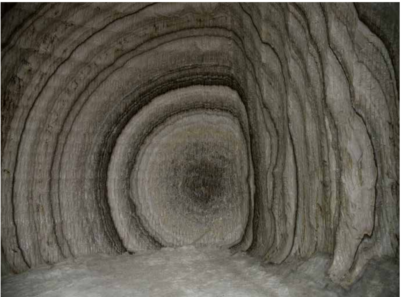
Fig. 4.10 – Alternanza di salgemma e Sali di potassio e magnesio in Miniera Racalmuto
