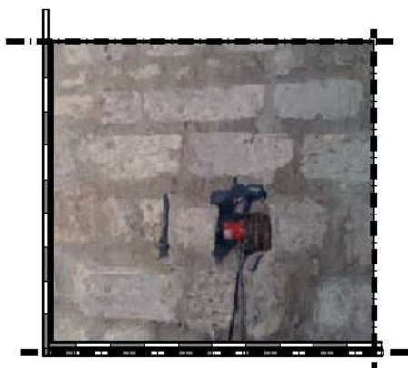
Ingranamento nel piano del paramento L.M.T=1,45 - P.R.
