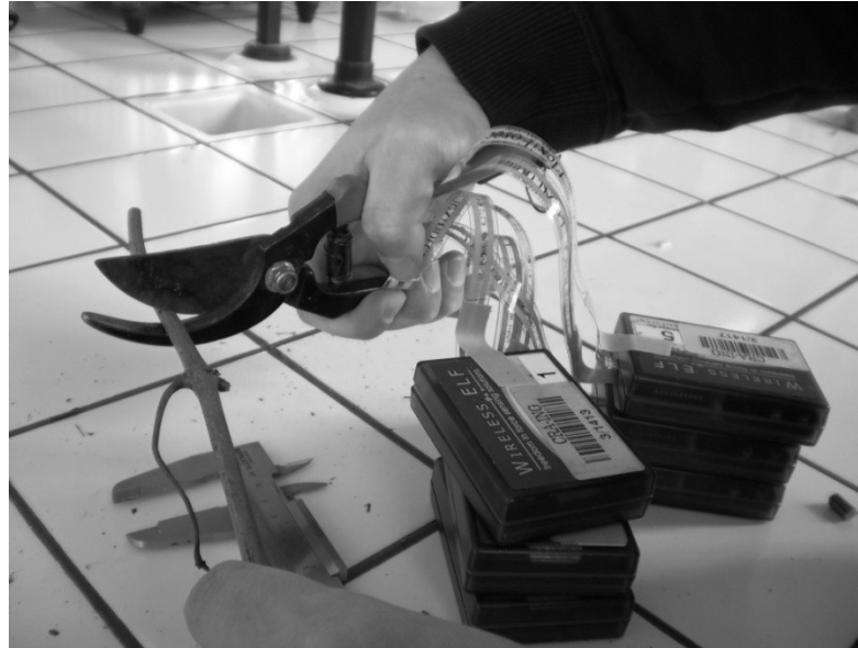
Fig. 7.11 – Sensori wireless applicati alla cesoia
