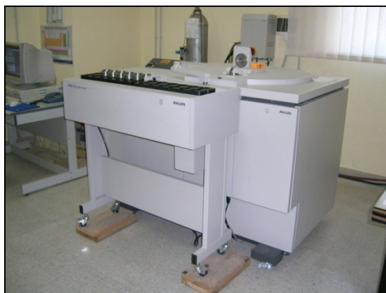
Fig. 6.1 Spettrometro di fluorescenza a raggi X, modello PHILIPS PW 2404 con caricatore di pastiche automatizzato.
