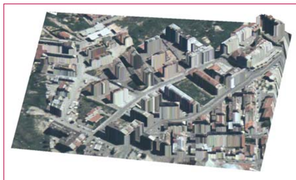
Fig.2 - Modello TIN con sovrapposizione di ortofoto di una parte del centro storico di S.Cataldo (CL)
