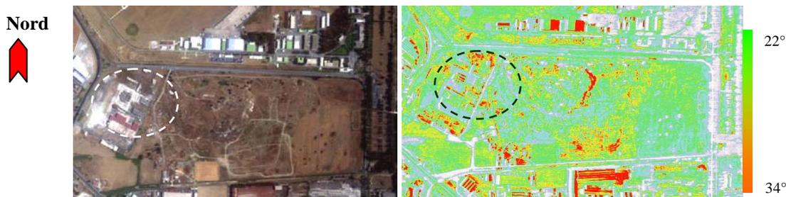
*Immagini della discarica in colori reali e in falsi colori sulla banda 93 (infrarosso termico 8,2  $\mu\text{m}$ ): a destra sono evidenti in rosso le aree caratterizzate da temperature più elevate*
