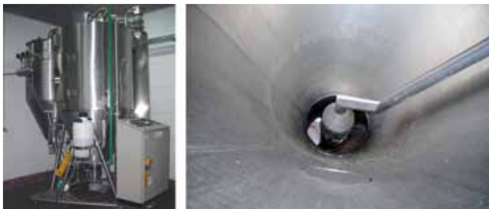
Fig.4. a) Impianto pilota spray-dryer impiegato per l'essiccamento di latte di asina (in secondo piano a sinistra si osserva il ciclone separatore delle polveri). b) Vista interna della camera di essiccamento con fondo conico e sistema per la raccolta delle polveri depositate sulle pareti.
