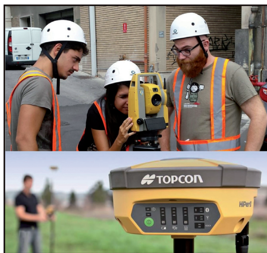
Fig. 2 – Squadra operatori in fase di misurazione con stazione totale e ricevitore GNSS.
