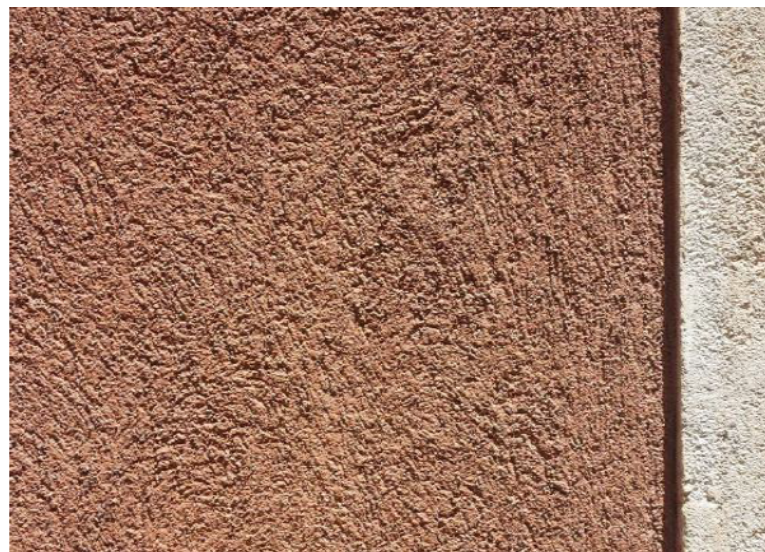
Fig. 1. Campione di malta naturale idraulicamente attiva priva di pigmenti artificiali
