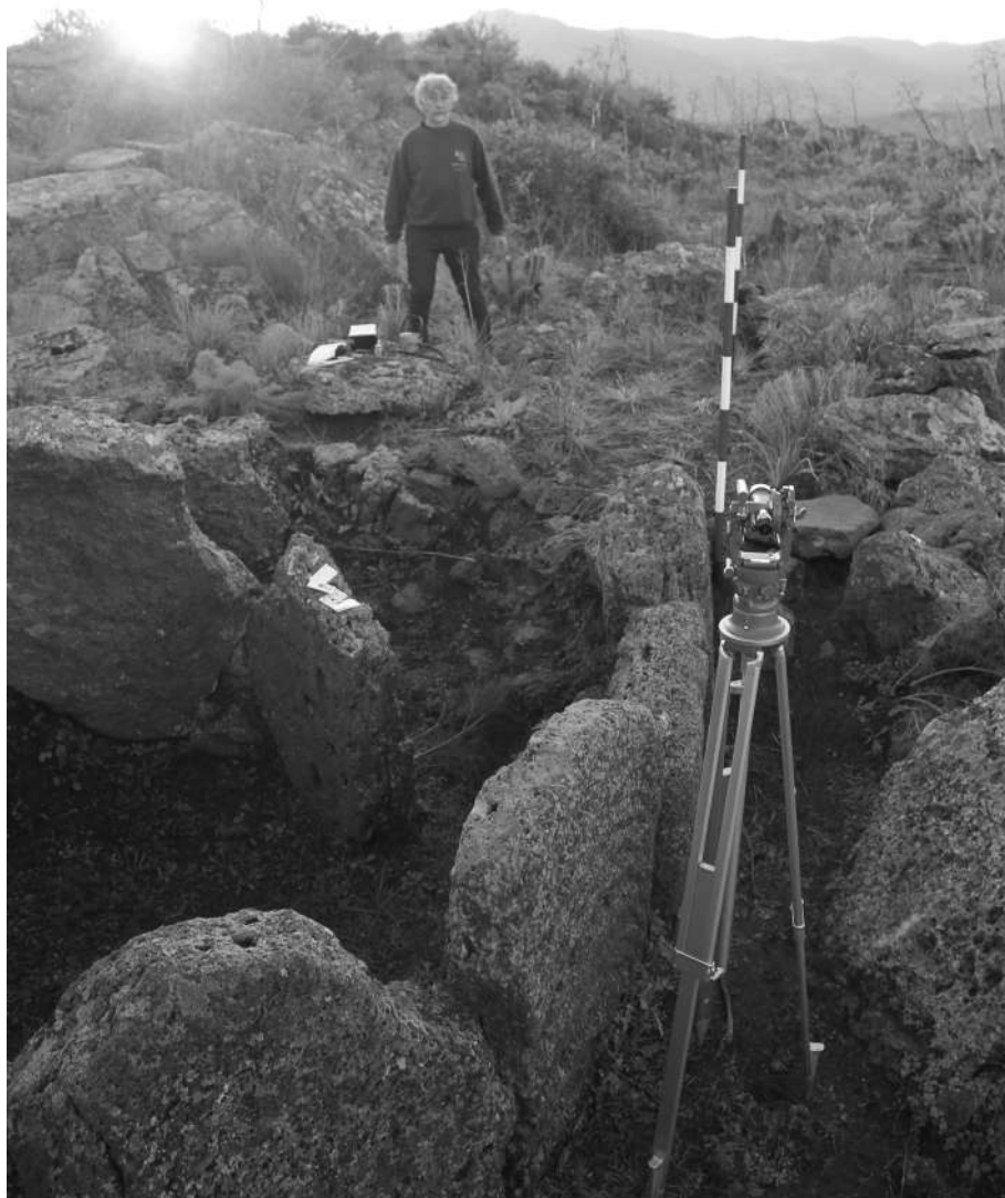
Fig. 8. Bronte, località Balze Soprane: misure di azimut con il teodolite alla spirale megalitica.
