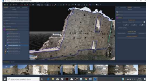
Fig. 6. Castello Belvedere, parte interna: tracciamento grafico manuale in 3D del nucleo a due elevazioni.
