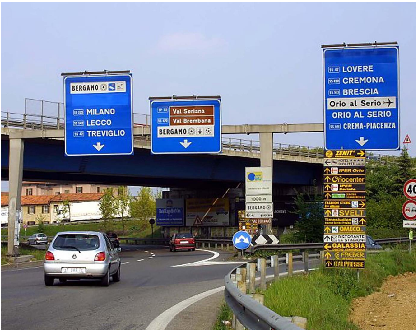
Un esempio di eccesso di informazioni provenienti dalla segnaletica verticale in un'area di svincolo
