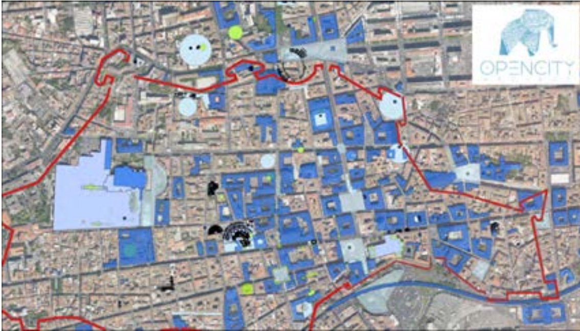
Fig. 1. OpenCiTy Project. Livelli informativi riguardanti l'edificato storico della città sovrapposti ad un'ortofoto aerea.
