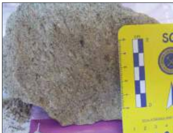
Fig. 10 - Campione delle arenarie della Formazione di Castelvete (CVT) utilizzato per le analisi petrografiche.
