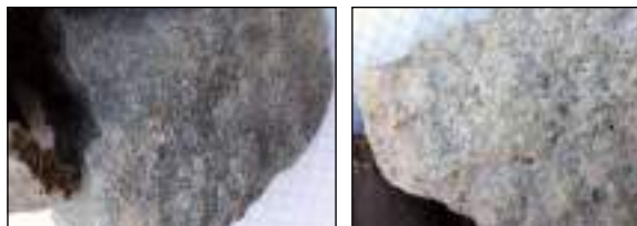
Fig. 24 - Galleria Pavoncelli bis campioni di arenarie a grana fine e grossa riferite alla Formazione di Castelvetere (CVT) prelevati dallo smarino tra pk 6210 m e pk 6220 m.
