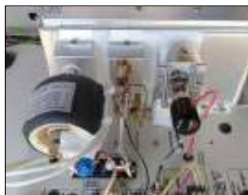
Figura 1. Vista dei tre rilevatori di cui è dotato il sistema MIP. Da sinistra: rilevatore DELCD, rilevatore FID e rilevatore PID.
