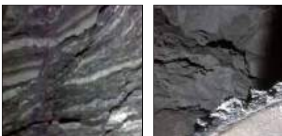
Fig. 22 - Galleria Pavoncelli bis pk 6170 m fronte scavo: Piega a stretto raggio nell'ambito della Formazione delle Arenarie di Corleto-Albanella. Si osserva l'alternanza di sottili strati di arenarie, siltiti ed argilliti, scompagnati dall'effetto della tettonica.
