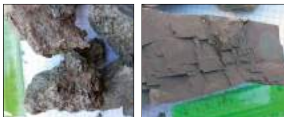
Fig. 26 - Galleria Pavoncelli bis: campioni di marne calcaree rosso vinaccia e argille con calcari biancastri riferiti alla formazione del Flysch Rosso prelevati intorno alla pk 7850 m circa.
