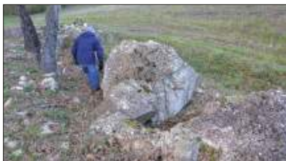
Fig. 6 - Calcareniti e calcilutiti in banchi e strati fratturati nelle Argille Varicolori Superiori a litofacies calcarea (ALVc).
