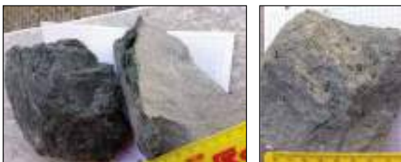
Fig. 23 - Galleria Pavoncelli bis: Campioni di arenarie e di argilliti grigio scuro appartenenti alla Formazione delle arenarie Corleto prelevati dallo smarino tra pk 6210 m e pk 6220 m.
