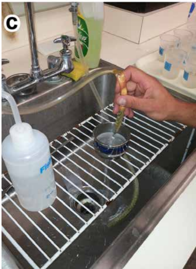
Fig. 3: fasi dell'estrazione e dello studio delle particelle di carbone macroscopiche conservate nei sedimenti. a) la carota di sedimenti viene campionata; b) i sedimenti vengono immersi per circa 24 ore in una soluzione ossidante e deflocculante; c) setacciatura dei sedimenti ormai disgregati; d) analisi del residuo allo stereomicroscopio.
