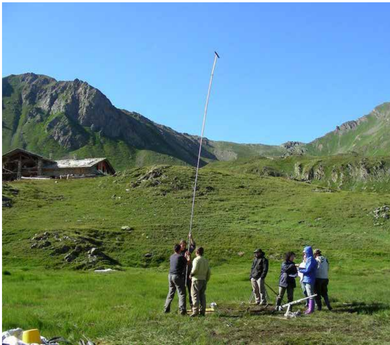
Fig. 2: il carotaggio stratigrafico che ha attraversato i depositi che riempiono la torbiera delle Crotte Basse (2365 m, Monte Fallère, Aosta). Il risultato delle operazioni è il recupero di un cilindro di limi, fanghi organici e torba lungo quasi 6 metri.
