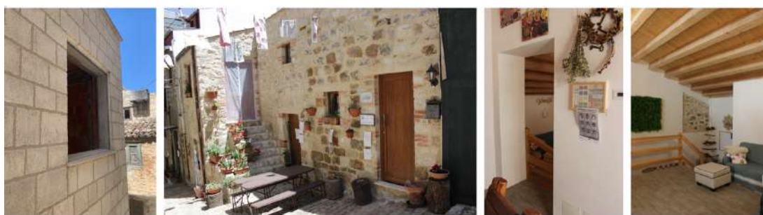
Fig. 4.14. Modalità d'intervento a confronto applicate all'edilizia più modesta. A sinistra: recente intervento ascrivibile alla categoria di ripristino tipologico che ha previsto la ricostruzione in cemento armato con apposizione di paramento che rievoca un "finto antico". Al centro e a destra: intervento della categoria "restauro" con significative alterazioni dell'assetto distributivo interno.
